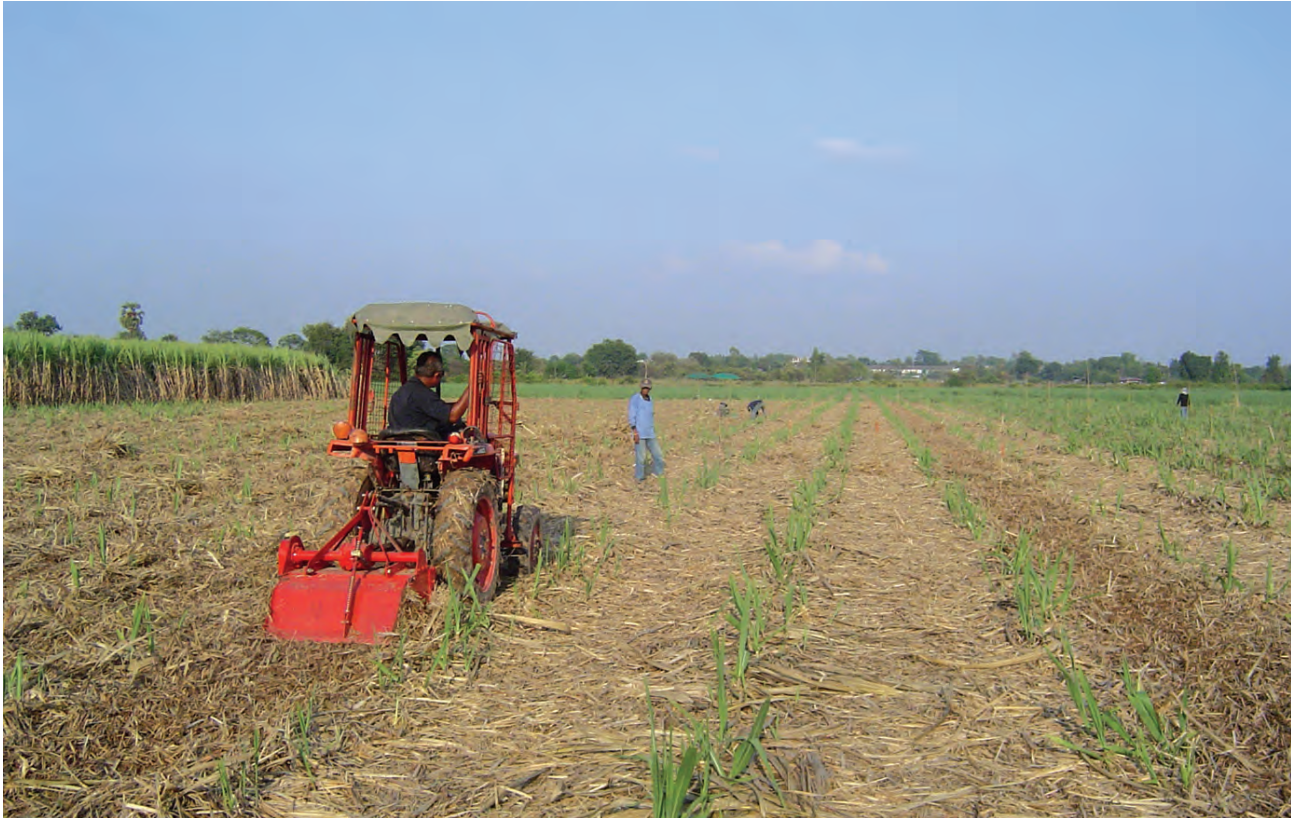
จอบหมุนติดพ่วงรถแทรกเตอร์ 24 แรงม้า พรวนดินสับกลบใบอ้อย
