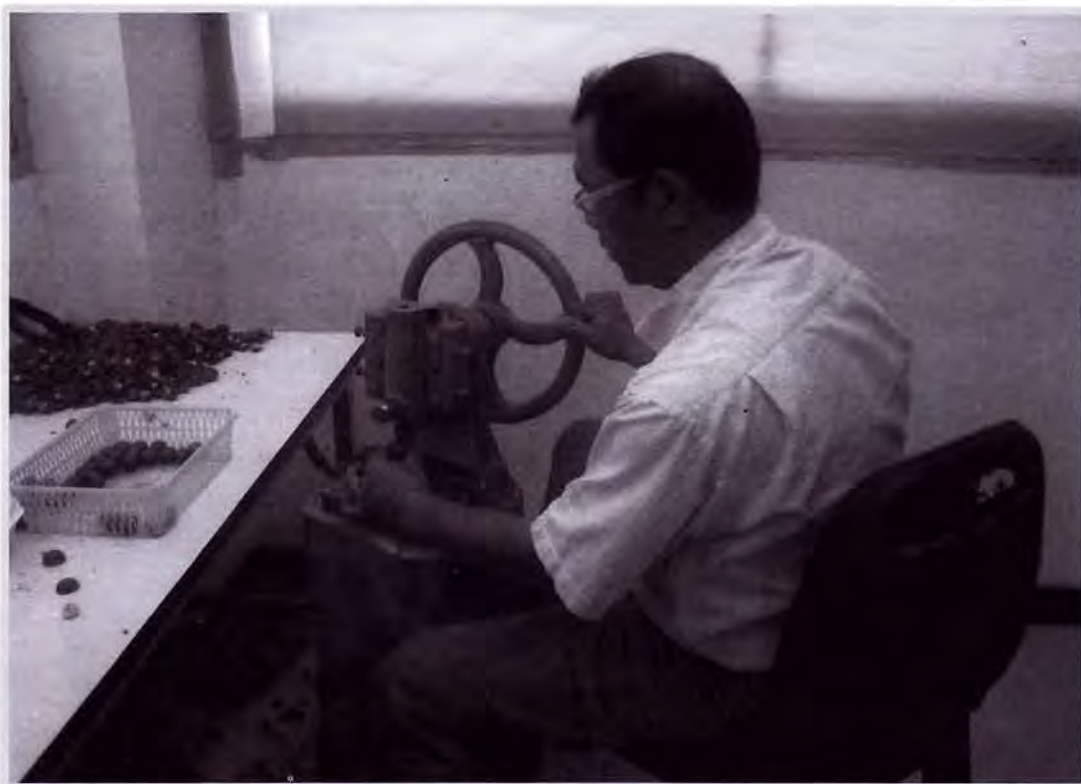
เครื่องกะเทาะกะลามะคาเดเมียออกแบบโดย นายประพัฒน์ ทองจันทร์ กำลังทดสอบการใช้งานของเครื่อง
