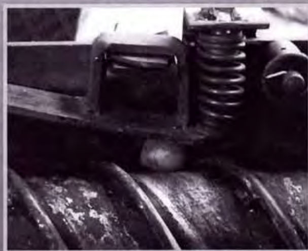
การกระเทาะเปลือกเมล็ดจะเลื่อนไปข้างหน้าด้วยเกลียวหมุนด้วยความเร็ว 330 รอบ/นาที และมีแผ่นบีบเมล็ดอยู่ด้านบนจะทำให้เปลือกแยกออกจากกะลา ถ้าต้องการแรงบีบมากขึ้นสามารถขันน็อต น็อตจะกดสปริงทำให้มีแรงบีบมากขึ้น
