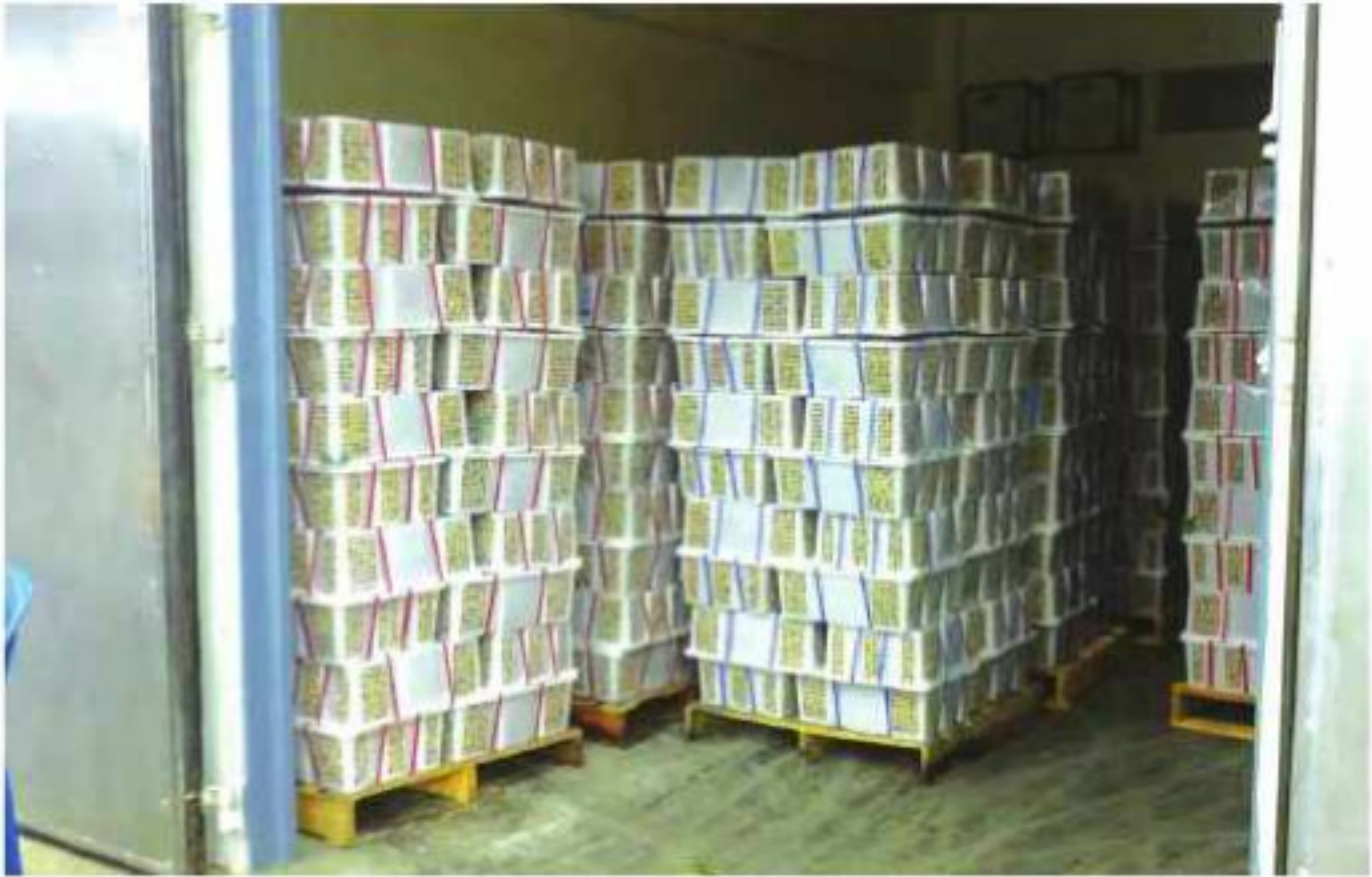
การจัดเรียงลำไยในห้องรมซัลเฟอร์ไดออกไซด์
