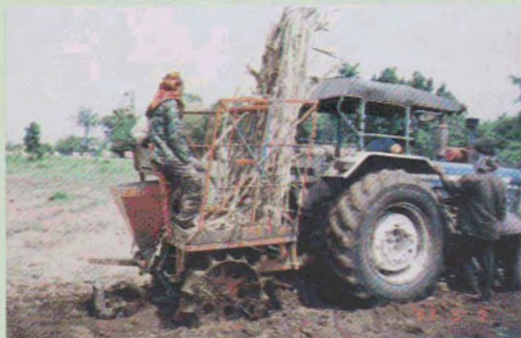
เครื่องปลูกอ้อยแบบแถวเดี่ยว
