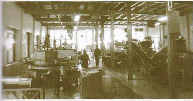
**การบด** เป็นกระบวนการที่ทำให้ใบชาบิดเป็นเกลียว เพื่อให้ผนังเซลล์แตกออกมา ซึ่งส่งผลให้น้ำที่อยู่ในเซลล์พืชแตกออกมาสู่ผิวใบ โรงงานแห่งนี้ใช้วิธีการบดชาด้วยเครื่อง เรียกว่า Rotorvane ใช้เวลาในการบดประมาณ 20 - 30 นาที ใบชาที่ผ่านเครื่องดังกล่าวจะมีทั้งใบชาที่บิดเป็นเกลียวและใบชาที่ไม่บิด ซึ่งจะผ่านเครื่องแยกออกจากกัน ใบชาที่ยังไม่บิดจะถูกส่งกลับไปผ่านเครื่องบดชาอีกครั้ง ส่วนใบชาที่บิดเป็นเกลียวจะผ่านไปสู่วัฏจักรกระบวนการหมัก
