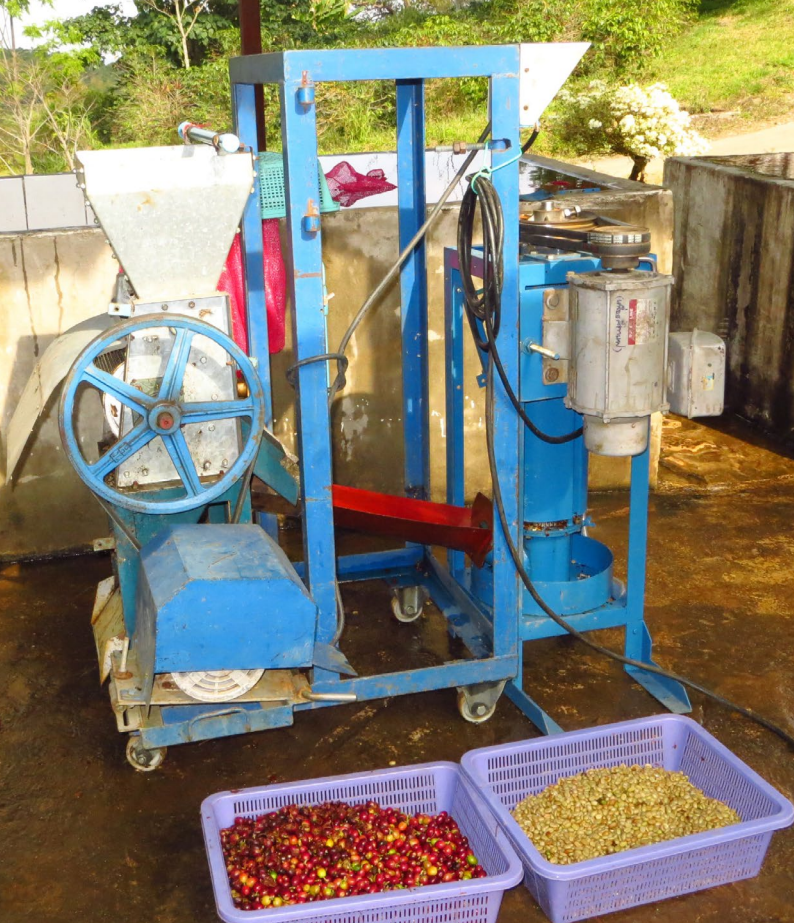
การทดสอบต้นแบบเครื่องขัดล้างเมือกกาแฟเบื้องต้นที่ศูนย์วิจัยเกษตรหลวงเชียงใหม่ (ขุนวาง)
