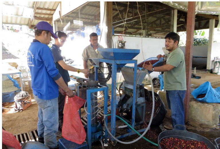
การทดสอบต้นแบบเครื่องขัดล้างเมือกกาแฟเบื้องต้นที่ศูนย์วิจัยเกษตรหลวงเชียงใหม่ (ขุนวาง)
