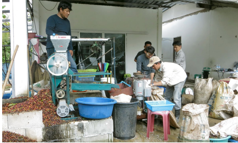
การทดสอบต้นแบบเครื่องขัดล้างเมือกกาแฟเบื้องต้นที่ศูนย์วิจัยเกษตรหลวงเชียงใหม่ (ขุนวาง)
