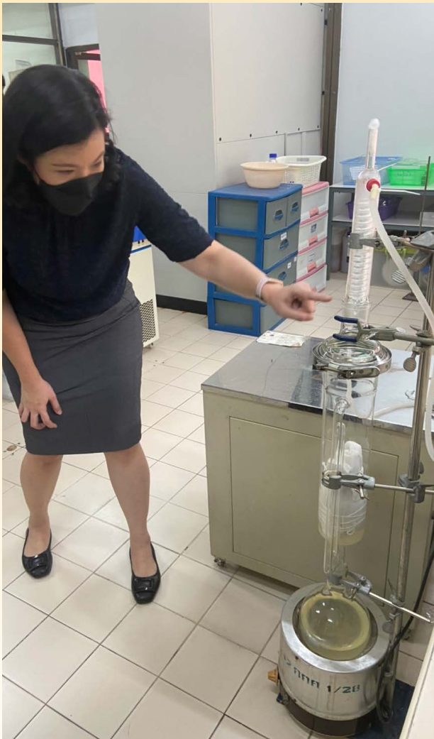
ชุดอุปกรณ์ที่ผลิตไขมันจากเนื้อในเมล็ดมะม่วง
