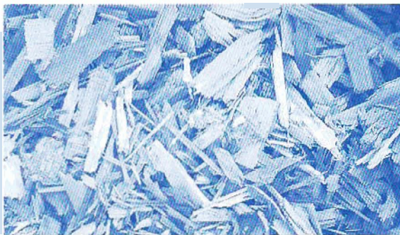
เศษไม้ หนึ่งในวัตถุดิบในการผลิตพลังงานไฟฟ้า
