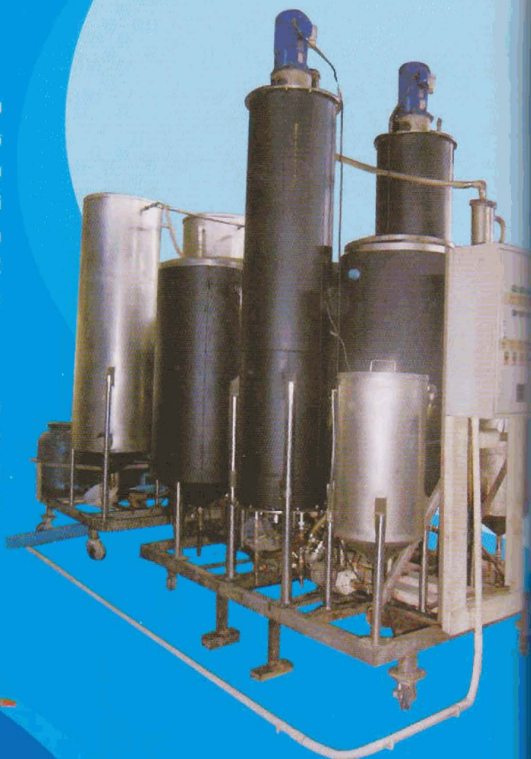
เครื่องผลิตไบโอดีเซลขนาดกำลังผลิต 300 ลิตร/วัน
