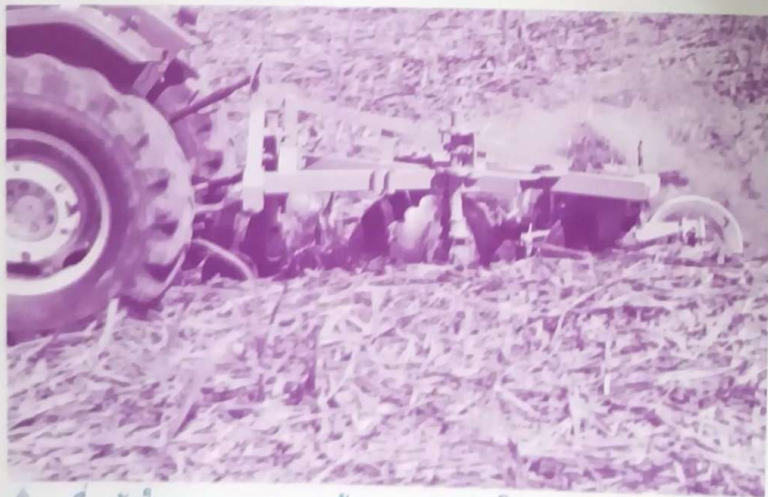
❖ เครื่องสับใบและกลบเศษซากอ้อยขณะทำงาน โดยผลจักร 1 คู่ จะตัดใบและเศษซากอ้อย และผลจักร 1 คู่ จะทำหน้าที่กลบใบและเศษซากอ้อยลงในดิน
