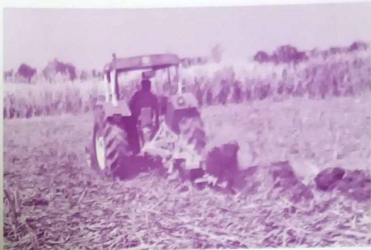
▲ เครื่องสับใบและกลบเศษซากอ้อย สามารถใช้ได้กับรถแทรกเตอร์ที่ชาวไร่ อ้อยมีอยู่แล้ว
