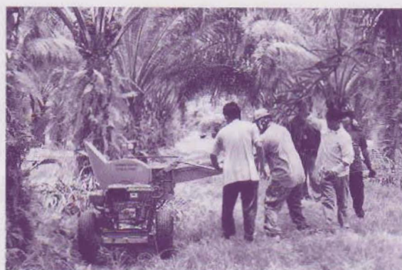
เครื่องหั่นย่อยทางปาล์ม ทำงานโดยใช้ ไบโอดีเซลน้ำมันปาล์ม
