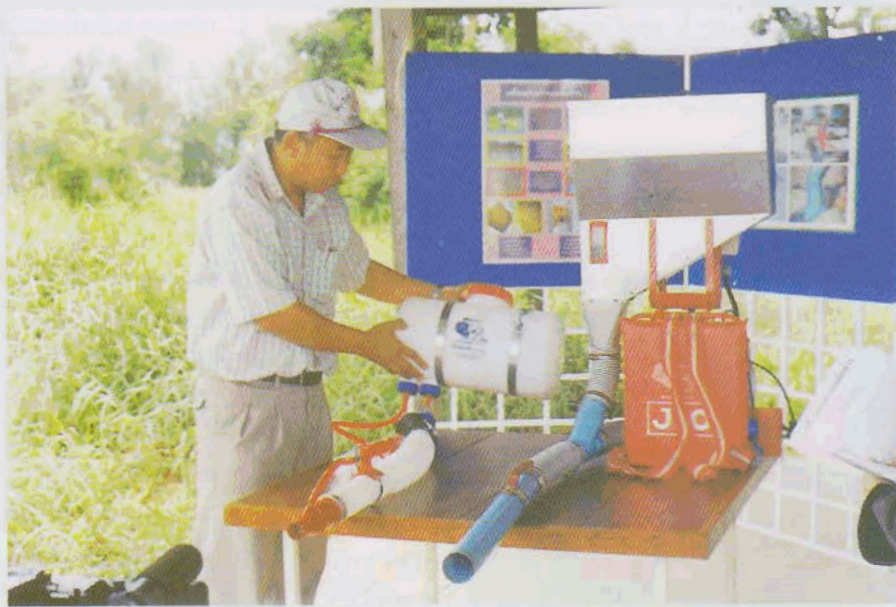
ถอดเอาถังพ่นยาออก ดัดแปลงถังอลูมิเนียมและท่อพีวีซีสวมแทนถังพ่นยาเป็นเครื่องพ่นน้ำตมหรือใช้พ่นปุ๋ยเม็ด หรือเมล็ดพันธุ์พืชอื่น ๆ ได้
