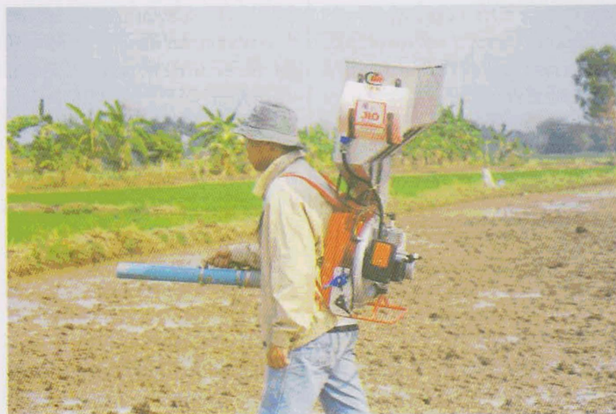
เครื่องพ่นน้ำตมที่ดัดแปลงจากเครื่องพ่นยาแบบสะพายหลัง
