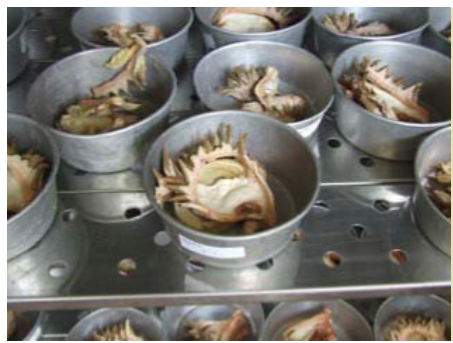
ภาพที่ 9 ขั้นตอนการอบแห้งใน การดำเนินการหาค่าเปอร์เซ็นต์ น้ำหนักแห้งหรือเนื้อแห้งโดย ตู้อบลมร้อน
