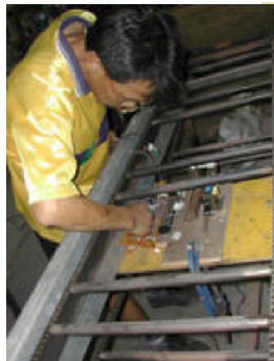
ภาพที่ 3 การติดตั้ง ทดสอบการทำงานของชุดลำเลียง และหัวเคาะ
