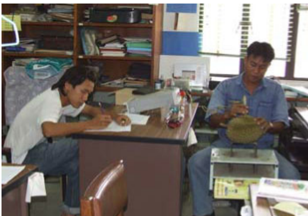
ภาพที่ 6 การวัดค่าความต้านทาน และความจุไฟฟ้าด้วยเครื่องวัดมาตรฐาน
