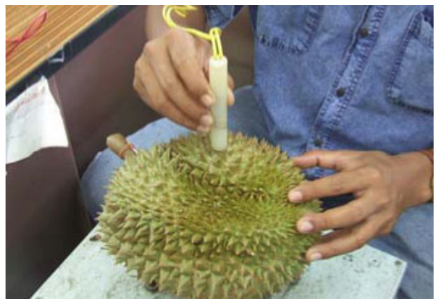
ภาพที่ 6 การวัดค่าความต้านทาน และความจุไฟฟ้าด้วยเครื่องวัดมาตรฐาน
