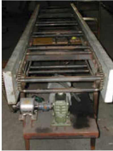
ภาพที่ 2 ชุดลำเลียงผลทุเรียน ประกอบด้วยถาดเหล็กบรรจุมอเตอร์ไฟฟ้า และวงจรควบคุม ตลอดจนถึงต้นกำลัง และการส่งกำลัง
