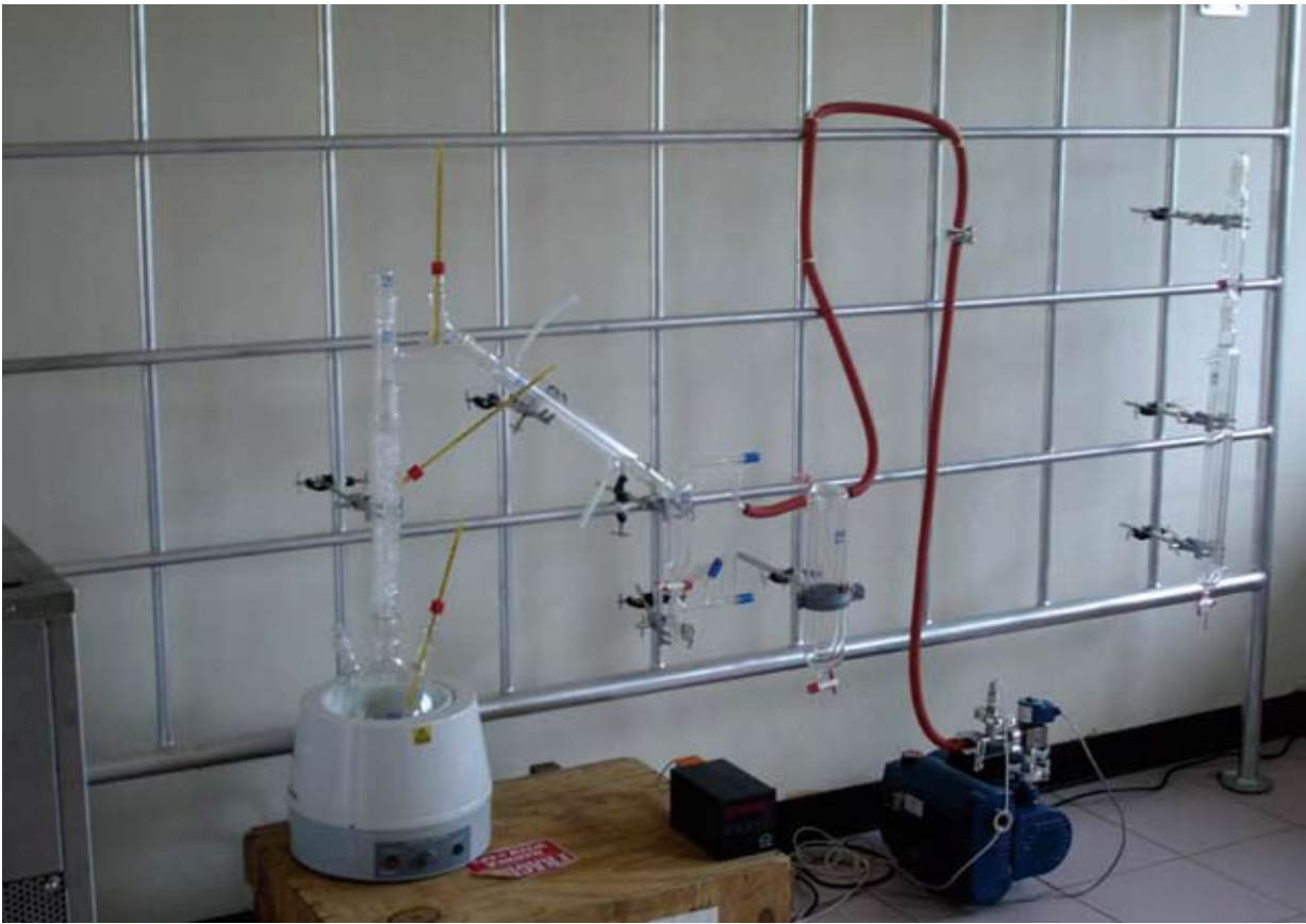
ภาพแสดง ชุดเครื่องกลั่นกลีเซอรินด้วยระบบสุญญากาศ
