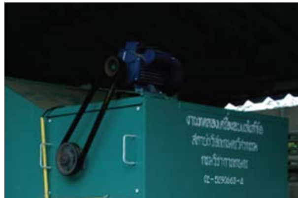
ภาพแสดง ลักษณะของเครื่องอบแห้งที่พัฒนาขึ้นให้เห็นห้องอบแห้งด้านล่างและห้องลมร้อนด้านบน
