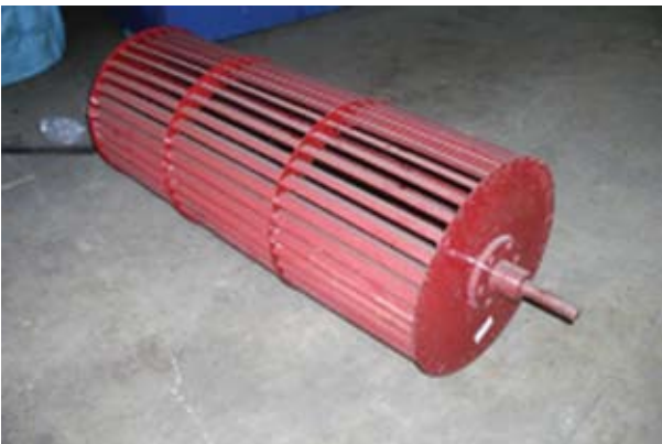
ภาพแสดง ลักษณะและการติดตั้งพัดลมกระจายลมร้อนแบบกรงกระรอก
