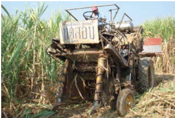
ภาพแสดง รถตัดอ้อยชนิดตัดเป็นลำ (whole stalk harvester) สามารถตัดอ้อยสดทั้งที่ตั้งและล้มได้
