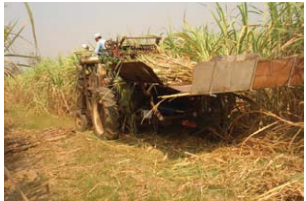
ภาพแสดง รถตัดอ้อยชนิดตัดเป็นลำ (whole stalk harvester) สามารถตัดอ้อยสดทั้งที่ตั้งและล้มได้
