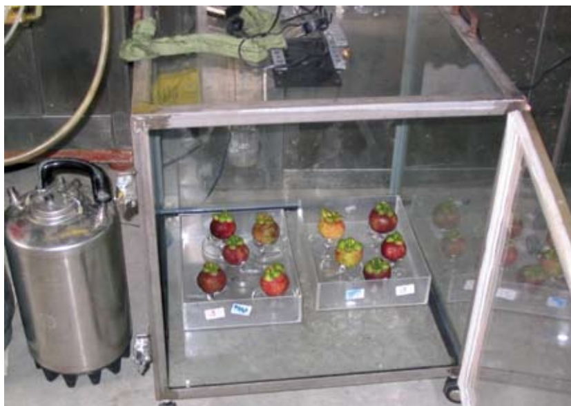
ภาพแสดง ตู้ทดลองขนาด 60x60x60 เซนติเมตร สำหรับรมสารเมทิลโบรไมด์
