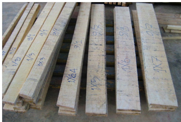
ไม้แปรรูปคัดเกรดคุณภาพและแยกตามขนาดความกว้างหน้าไม้
