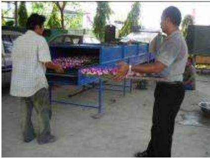
ภาพที่ 20 วิธีลดความชื้นโดยใช้ลมอุณหภูมิแวดล้อม
