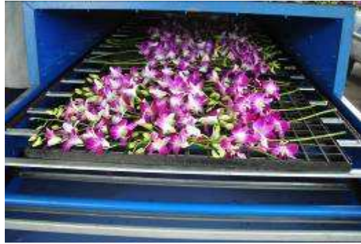
ภาพที่ 19 การลดความชื้นกล้วยไม้ในลักษณะต่อเนื่อง
