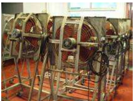
ภาพที่ 11 พัดลมที่ใช้ลดความชื้นกล้วยไม้ในโรงคัดบรรจุ
