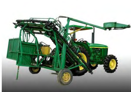
ภาพที่ 2.4 ตัวอย่างรถตัดอ้อยแบบเป็นลำที่มีจำหน่ายในท้องตลาด
