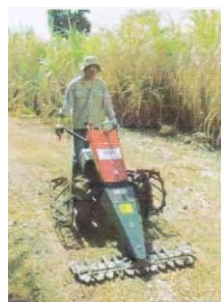
ภาพที่ 2.4 ตัวอย่างรถตัดอ้อยแบบเป็นลำที่มีจำหน่ายในท้องตลาด
