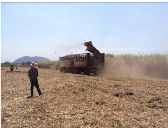
ภาพที่ 2.13 การใช้เครื่องในพื้นที่แคบ มีสิ่งกีดขวาง ทำให้ประสิทธิภาพการใช้งานค่อนข้างต่ำ
