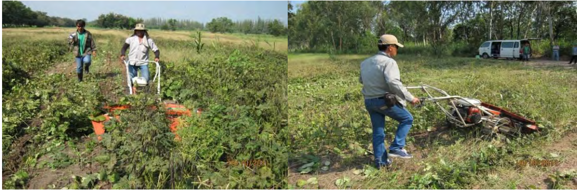
ภาพที่ 2.6 การทดสอบการเก็บเกี่ยวถั่วเขียวด้วยเครื่องเกี่ยววางราย
