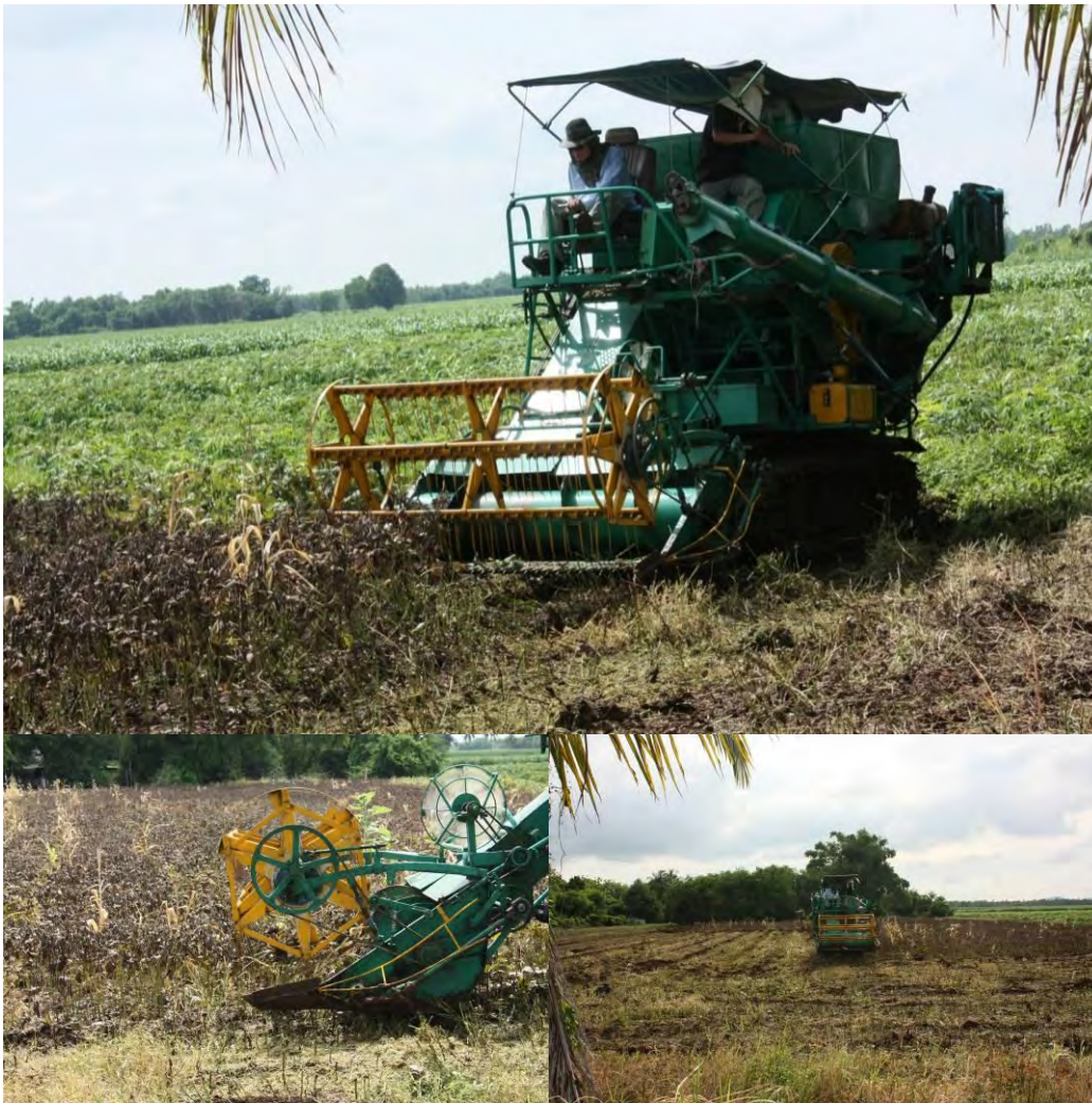
ภาพที่ 2.8 ทดสอบเครื่องเกี่ยวนวดถั่วเขียวในแปลงเกษตรกรที่จังหวัดนครสวรรค์
