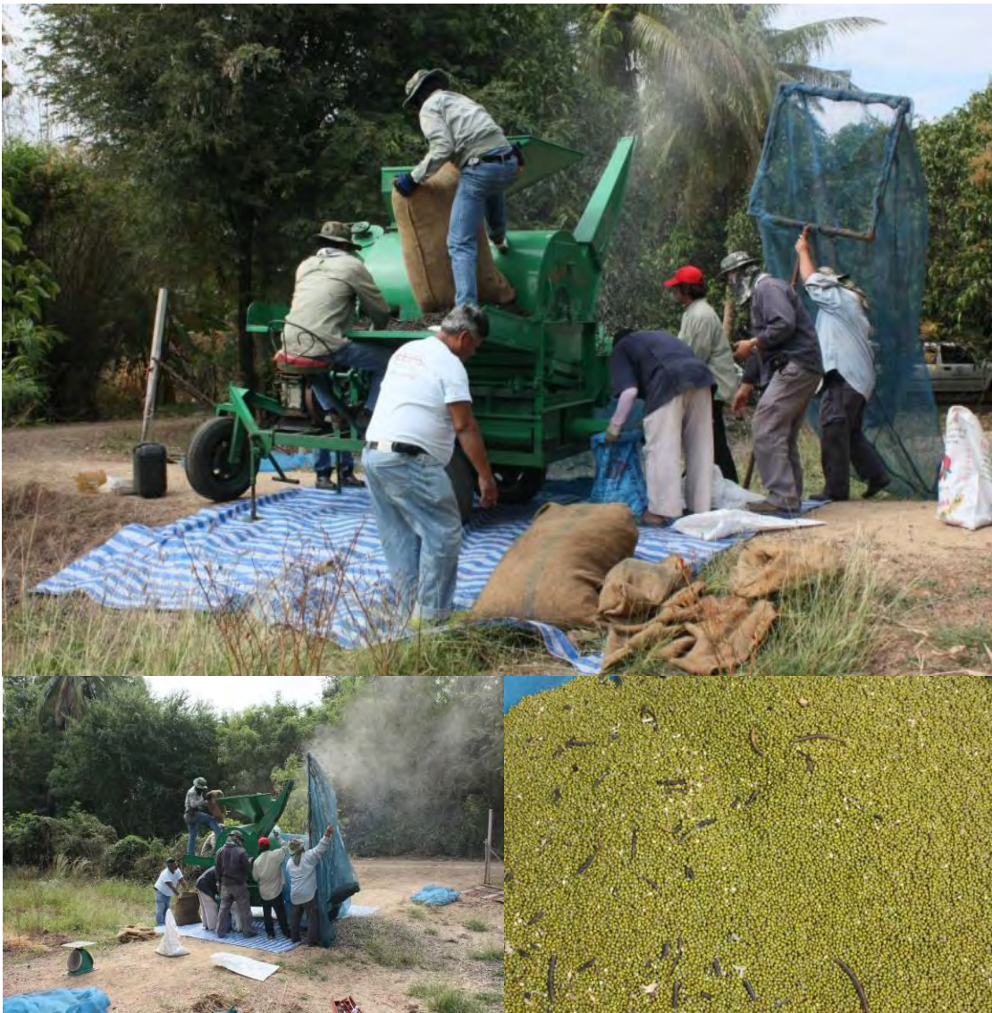
ภาพที่ 2.4 การทดสอบเครื่องกะเทาะฝักถั่วเขียว ที่เก็บเกี่ยวด้วยแรงงานคน โดยไม่พ่นยาก่อนเก็บเกี่ยว
