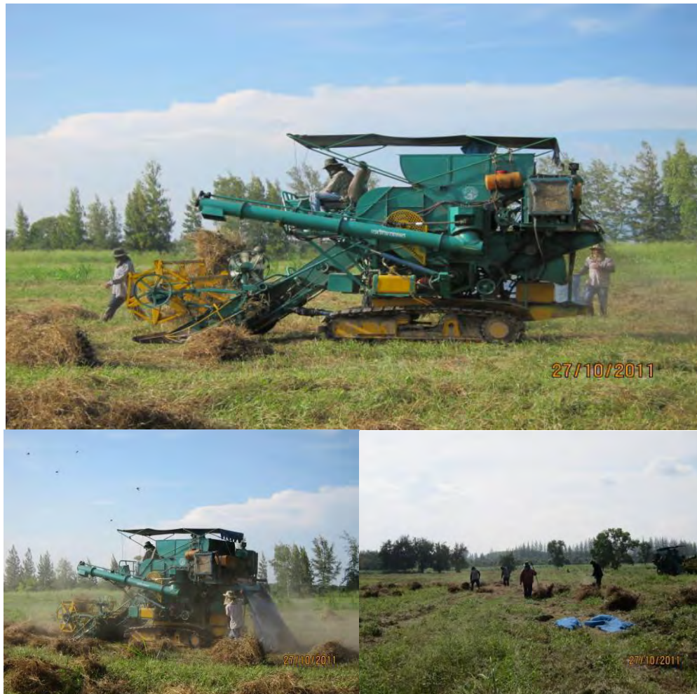
ภาพที่ 2.7 ทดสอบเครื่องเกี่ยวขนาดสำหรับนวดถั่วเขียวทั้งต้นที่เก็บเกี่ยวด้วยเครื่องเกี่ยววางราย
