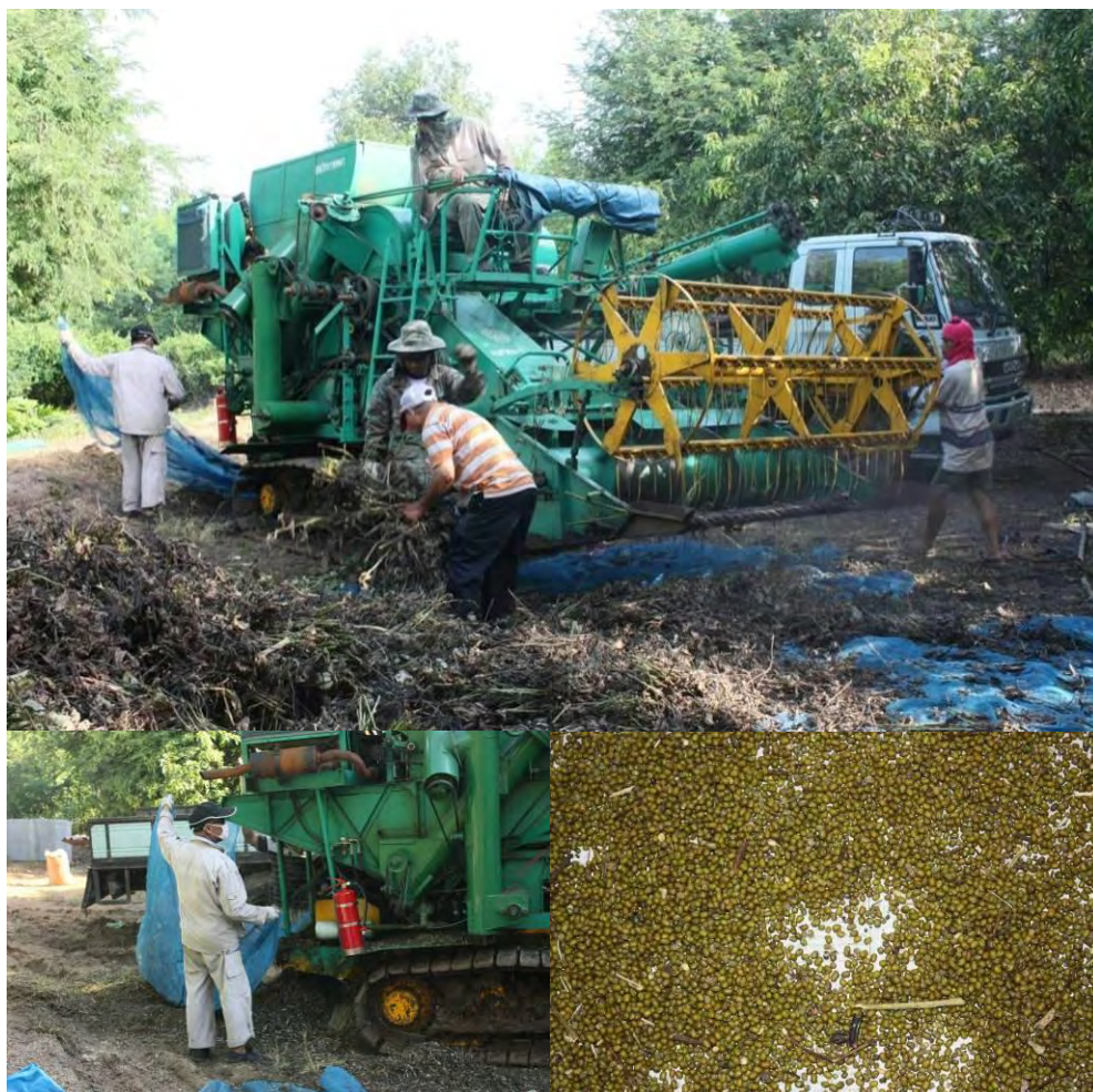
ภาพที่ 2.5 การทดสอบระบบขนาดและระบบคัดทำความสะอาดของต้นแบบเครื่องเกี่ยวขนาดถั่วเขียว ที่เก็บเกี่ยวด้วยแรงงานคน โดยพนักยกริมมือโกโซน ก่อนเก็บเกี่ยว 4 วัน
