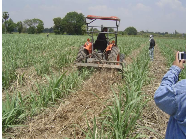
ภาพที่ 2.23 ไบอ้อยที่ผ่านเครื่องสับไบและเศษซากอ้อย
