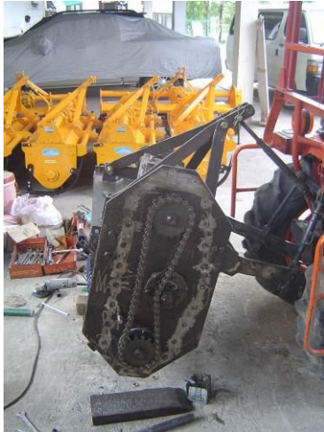
ภาพที่ 2.24 แสดงเครื่องสับใบอ้อยด้านข้าง
