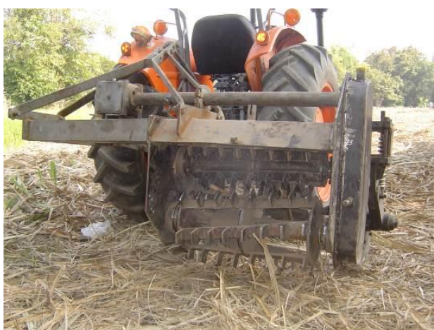
ภาพที่ 2.13 แสดงต้นแบบเครื่องสับใบอ้อยแบบ 2 ลูกตี
