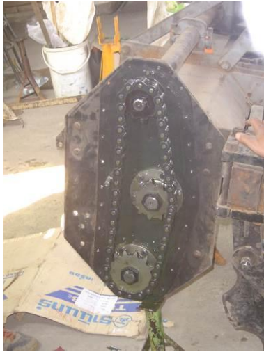
ภาพที่ 2.14 แสดงการใช้โซ่ขับเคลื่อนตามกัน ภาพที่ 2.15 แสดงการใช้โซ่ขับเคลื่อนสวนกัน
