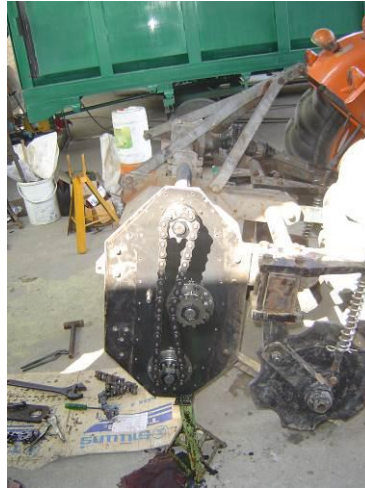
ภาพที่ 2.14 แสดงการใช้โซ่ขับเคลื่อนตามกัน ภาพที่ 2.15 แสดงการใช้โซ่ขับเคลื่อนสวนกัน
