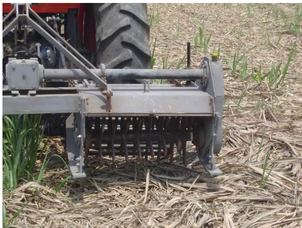
ภาพที่ 2.9 ชุดลูกตีมี่ลักษณะเป็นเหล็กพืดแบน
