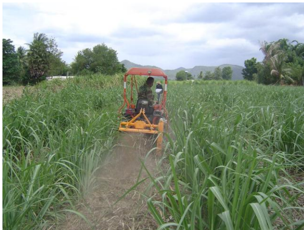
ภาพที่ 2.27 แสดงผลการทำงานเครื่องสับใบอ้อยฟังแทรกเตอร์ 24 แรงม้า
