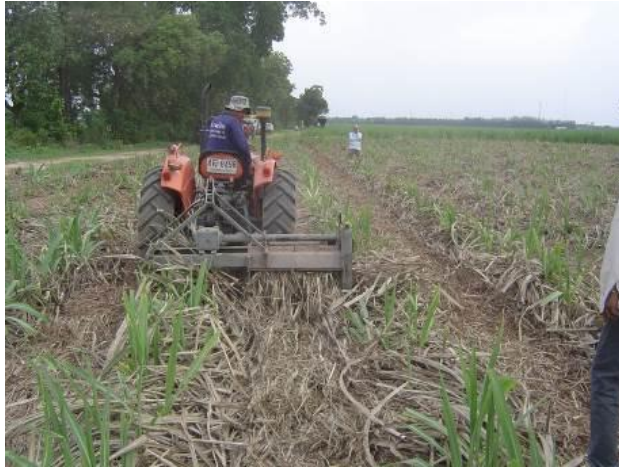
ภาพที่ 2.10 แสดงการใช้แทรกเตอร์ขนาด 34 แรงม้าติดเครื่องสับใบอ้อยและใบอ้อยเข้ามาพันแกนลูกดี
