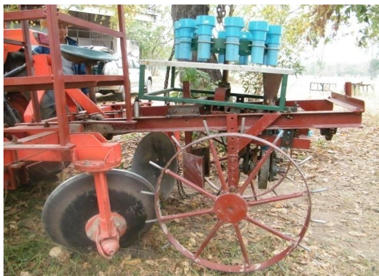
ภาพที่ 3.20 การปรับเอียงทิศทางการปักของล้อปัก
