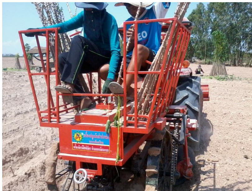
ภาพที่ 3.5 เครื่องปลูกมันสำปะหลังของภาคเอกชน จ.นครสวรรค์
