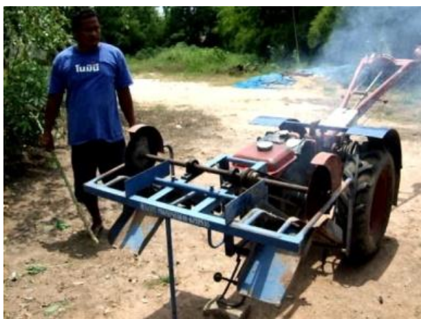
ภาพที่ 1.2 ตัดท่อนพันธู้ำมันสำปะหลังโดยผลิตในโรงงานท้องถิ่น ต.หนองหลวง อ.ท่าตะโก จ.นครสวรรค์
