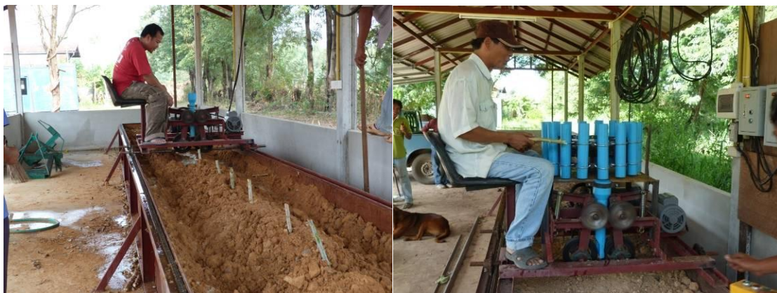
ภาพที่ 2.6 การทดสอบความเร็วการปลูกที่มีต่อลักษณะการปลูกท่อน้ำมันสำปะหลังบนรางดิน
