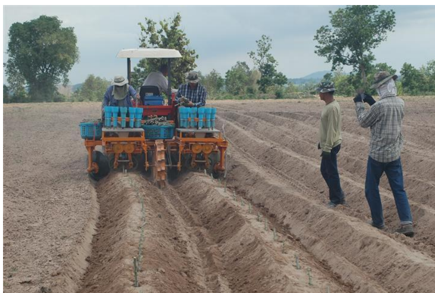
ภาพที่ 3.23 ทดสอบเครื่องปลูกลำไยสำหรับปลูกลำไยแบบ 2 แถว
