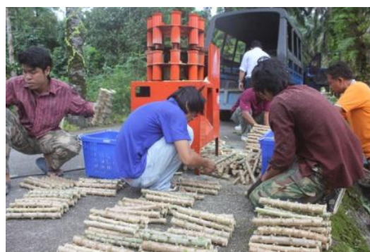
รูปที่ 7 การดำเนินการทดสอบประเมินสมรรถนะการตัดท่อนพันธุ์มันสำปะหลัง การตัดด้วยเครื่องตัดท่อนพันธุ์มันสำปะหลังและการตัดด้วยแรงงานคน
