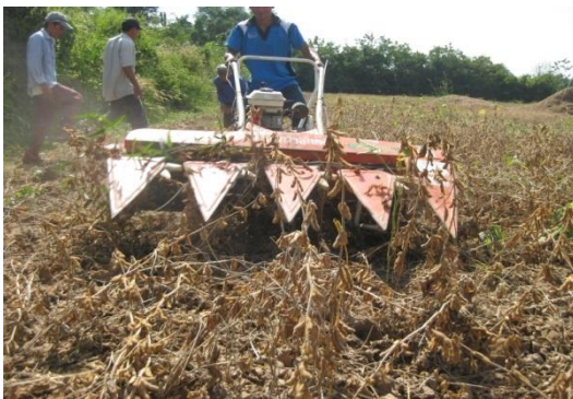
การทดสอบเครื่องเกี่ยวแบบวางรายและเครื่องเกี่ยววางรายแบบดีดรถแทรกเตอร์
