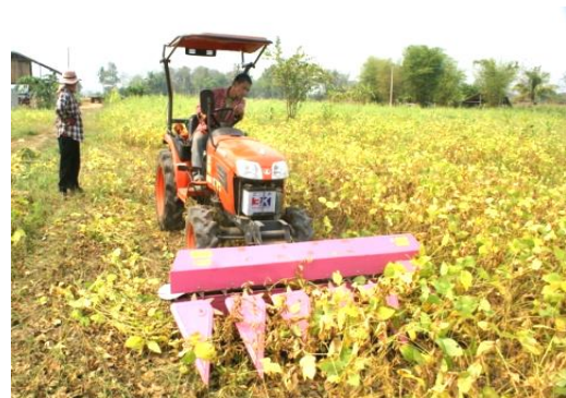
การทดสอบเครื่องเกี่ยวแบบวางรายและเครื่องเกี่ยววางรายแบบดีดรถแทรกเตอร์
