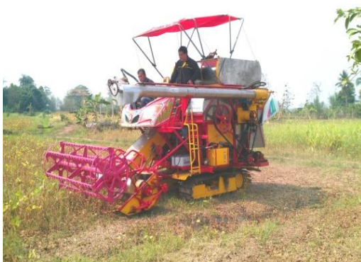
การทดสอบเครื่องเกี่ยวขนาดและการสุ่มตัวอย่างเปอร์เซ็นต์การสูญเสียจากเครื่องเกี่ยวขนาด
