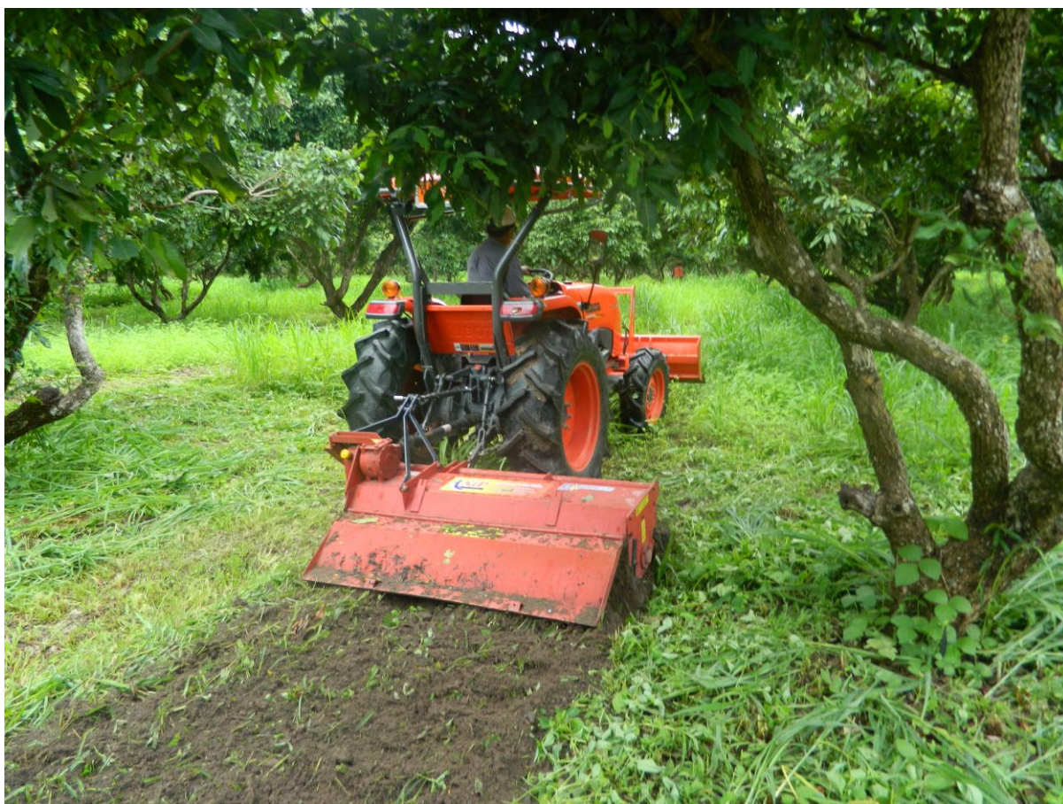
ภาพที่ 2 รถแทรกเตอร์ขนาด 40 แรงม้า ติดจอบหมุนแบบเยื้องข้างศูนย์ทำการทดสอบในสวนลำไย
