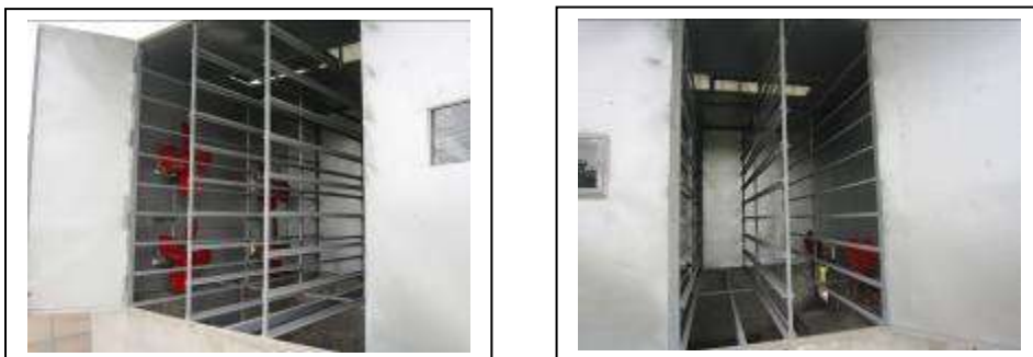
ภาพที่ 1.3-3 แสดงภาพระบบการกระจายลมร้อนด้วยพัดลมและช่องเปิดด้านบนโรงอบแห้งลำไย
