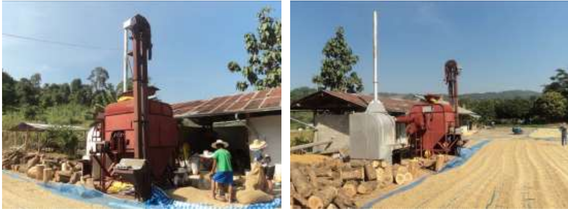
รูปที่ 12 การใช้งานต้นแบบเครื่องอบแห้งกาแฟพร้อมเตาชีวมวลกำเนิดลมร้อน
