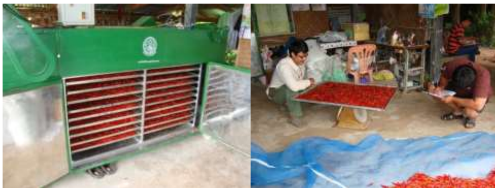
ภาพที่ 9 เครื่องอบแห้งแบบชั้นวางชนิดแหล่งกำเนิดความร้อนจากแก๊สหุงต้ม
