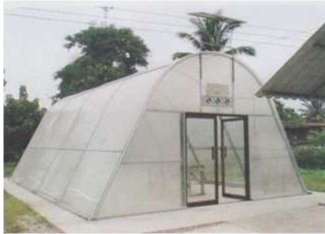
ภาพที่ 2 เครื่องอบแห้งพลังงานแสงอาทิตย์สะสมความร้อนแบบภาวะเรือนกระจก
