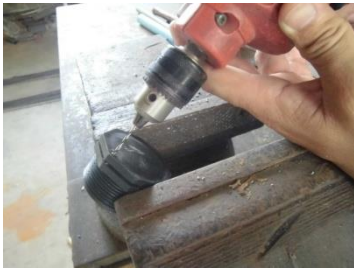
(ก) นำฝาปิดไปเจาะเพื่อใส่เชือกเอ็น
