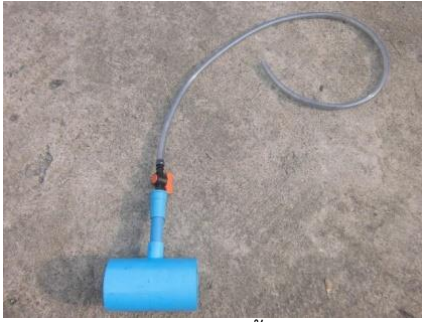
(ก) ข้อต่อแยกออกเป็นวาล์ว ½ นิ้ว พร้อมสายยาง 4 หลุน ยาวประมาณ 1.20 เมตร
