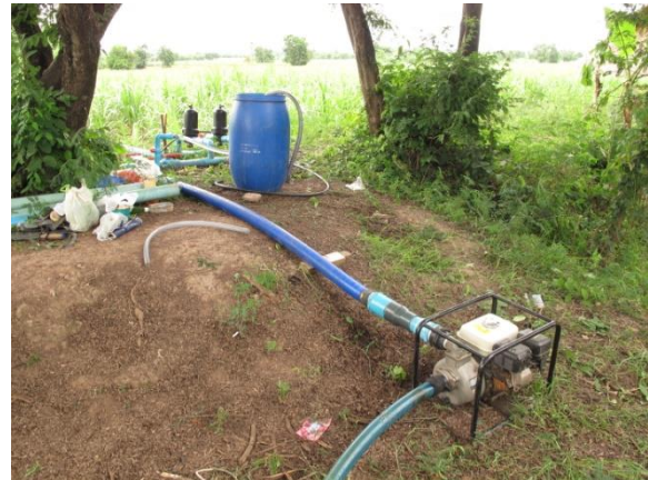
(ข) เครื่องสูบน้ำเบนซินขนาด 2 นิ้ว (5 แรงม้า)
