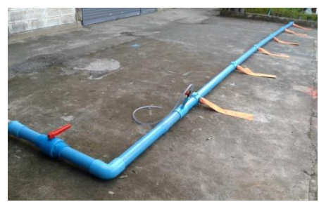
(ค) ท่อจ่ายน้ำตามร่องที่สวมท่ออ่อนป้องกันการกัดเซาะดิน
