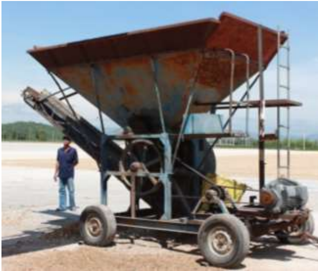
รูปที่ 9 เครื่องสับมันเส้น ใบสับเป็นแบบจานหมุน จำเป็นต้องได้รับการพัฒนาให้สามารถสับได้ขนาดที่สม่ำเสมอ และประหยัดพลังงาน
