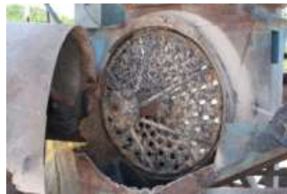
รูปที่ 9 เครื่องสับมันเส้น ใบสับเป็นแบบจานหมุน จำเป็นต้องได้รับการพัฒนาให้สามารถสับได้ขนาดที่สม่ำเสมอ และประหยัดพลังงาน
