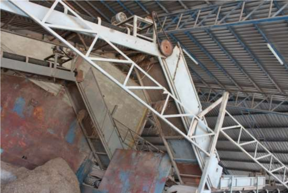
รูปที่ 7 ส่วนที่เป็นตะแกรงร้อนสำหรับทำความสะอาด
