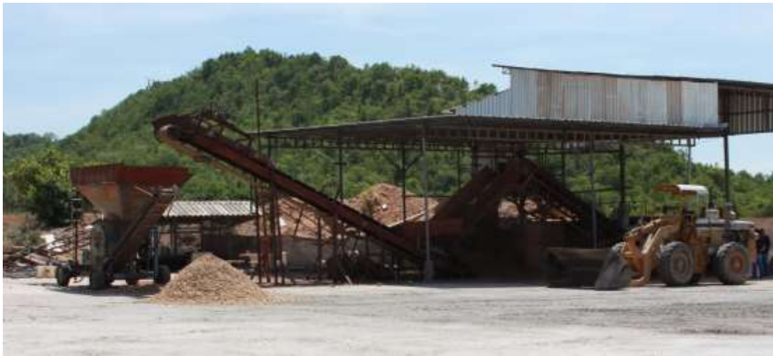
รูปที่ 5 เครื่องทำความสะอาดหัวมันสำปะหลังแบบสายพานและตะแกรงร่อน (1 ตะแกรง)
