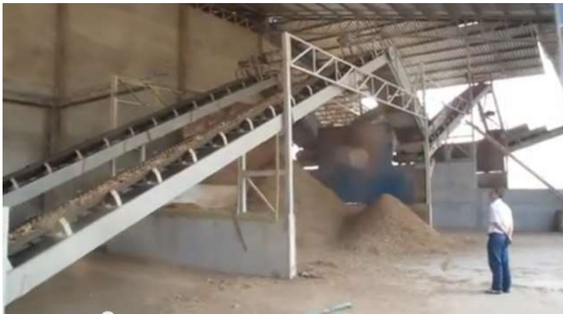
รูปที่ 6 เครื่องทำความสะอาดหัวมันสำปะหลังแบบสายพานและตะแกรงร่อน (2 ตะแกรง) เพิ่มความสามารถในการทำงานโดยการเพิ่มจำนวนชุด
