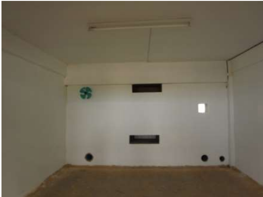
รูปแบบที่ 3 ใช้พัดลมช่วยในการกระจายตัวของแก๊สซัลเฟอร์ไดออกไซด์
