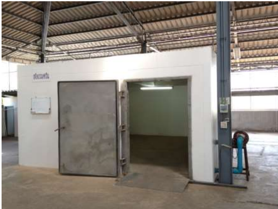
รูปแบบที่ 1 ใช้มอเตอร์ช่วยในการกระจายตัวของแก๊สซัลเฟอร์ไดออกไซด์
