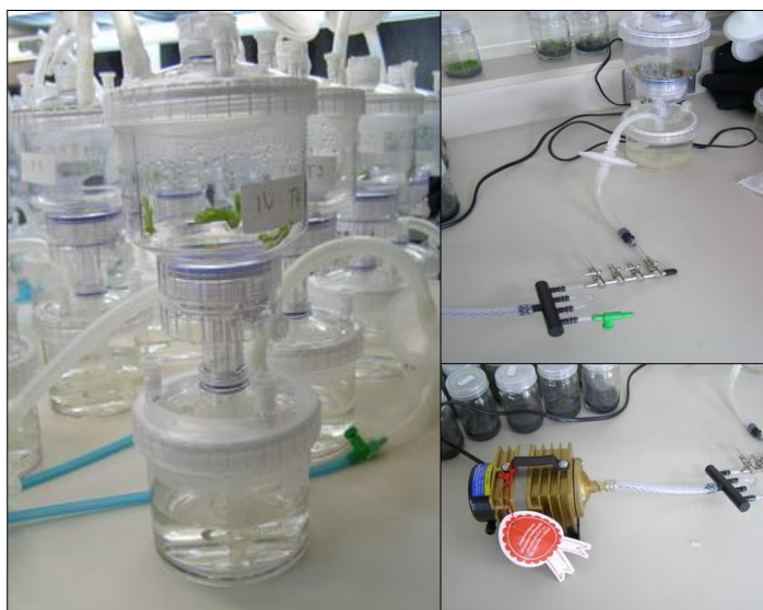
ภาพที่ 3 เทมโพรารีไบโอรีแอกเตอร์ที่ประกอบขึ้นใช้ในการทดลอง
