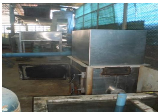
ภาพผนวกที่ 3 โรงรมแบบที่ 4 มีอุปกรณ์ช่วยในการหล่อเย็น
