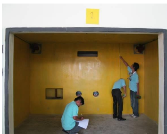
ภาพผนวกที่ 2 โรงรมแบบที่ 3 ใช้พัดลมช่วยในการกระจายตัวของซิลเฟอร์ไดออกไซด์
