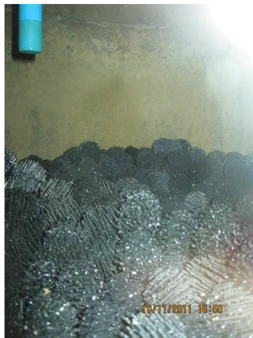
ภาพผนวกที่ 8 แสดงการดูดแก๊สซิลเฟอร์ไดออกไซด์ออกจากห้องรม และวัสดุสำหรับใช้ในหอบำบัด
