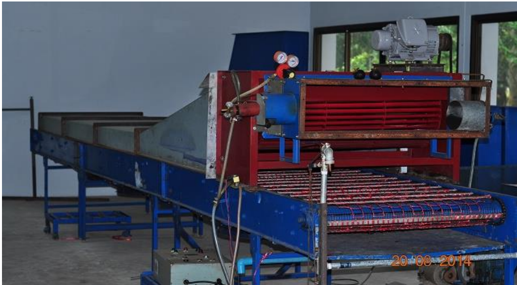
รูปที่ 1 ต้นแบบเครื่องเป่าแห้งมั่งคุดสดหลังการปรับปรุง
