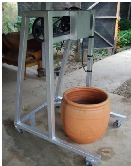
ภาพที่ 6 ต้นแบบเครื่องกวนน้ำห่อม แบบที่ 3 แบบตีขึ้น-ลงความเร็วในการตีคองที่200 ครั้ง/นาที
