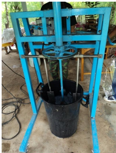
ภาพที่ 3 ต้นแบบเครื่องกวนน้ำหอม แบบที่ 1 แบบใบกวน
