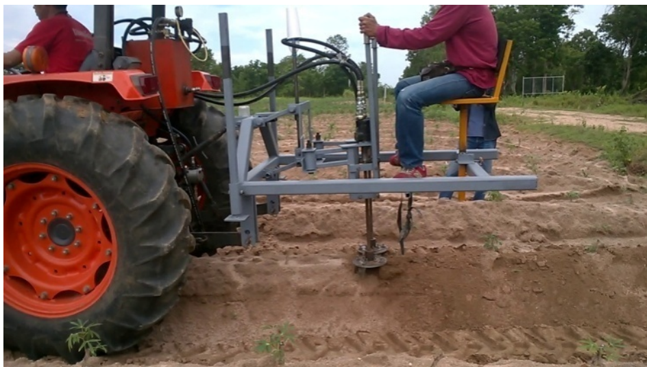
รูปที่ 12 ทดสอบการทำงานเบื้องต้นของส่วนกำจัดวัชพืชระหว่างต้น
