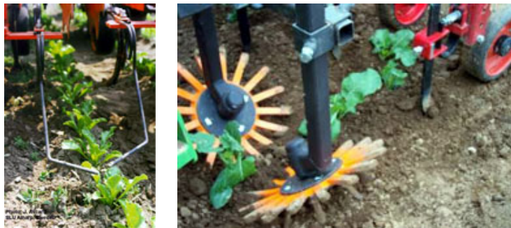
รูปที่ 4 อุปกรณ์กำจัดวัชพืชแบบระหว่างต้น
