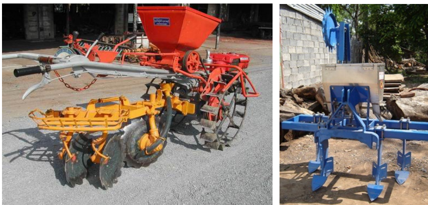
รูปที่ 2 เครื่องพรวนดินและใส่ปุ๋ยติดรถไถเดินตามหรือรถแทรกเตอร์
