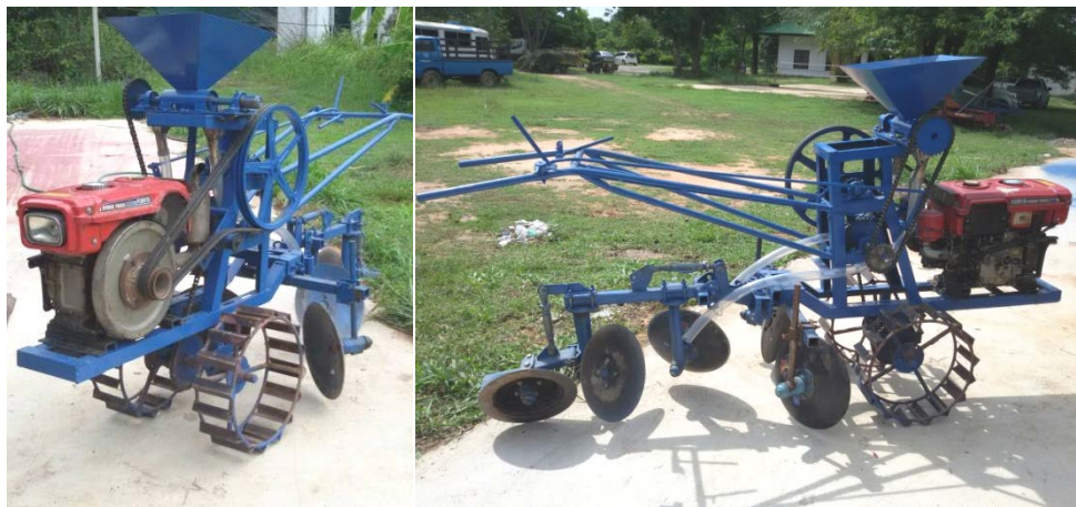
รูปที่ 13 ต้นแบบเครื่องกำจัดวัชพืชพร้อมยกทรงกลบปุ๋ยในร่องมันสำปะหลังแบบเดินตาม
