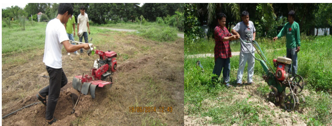
รูปที่ 4 การทดสอบเครื่องมือพรวนดินเพื่อหาแนวทางการออกแบบที่เหมาะสม
