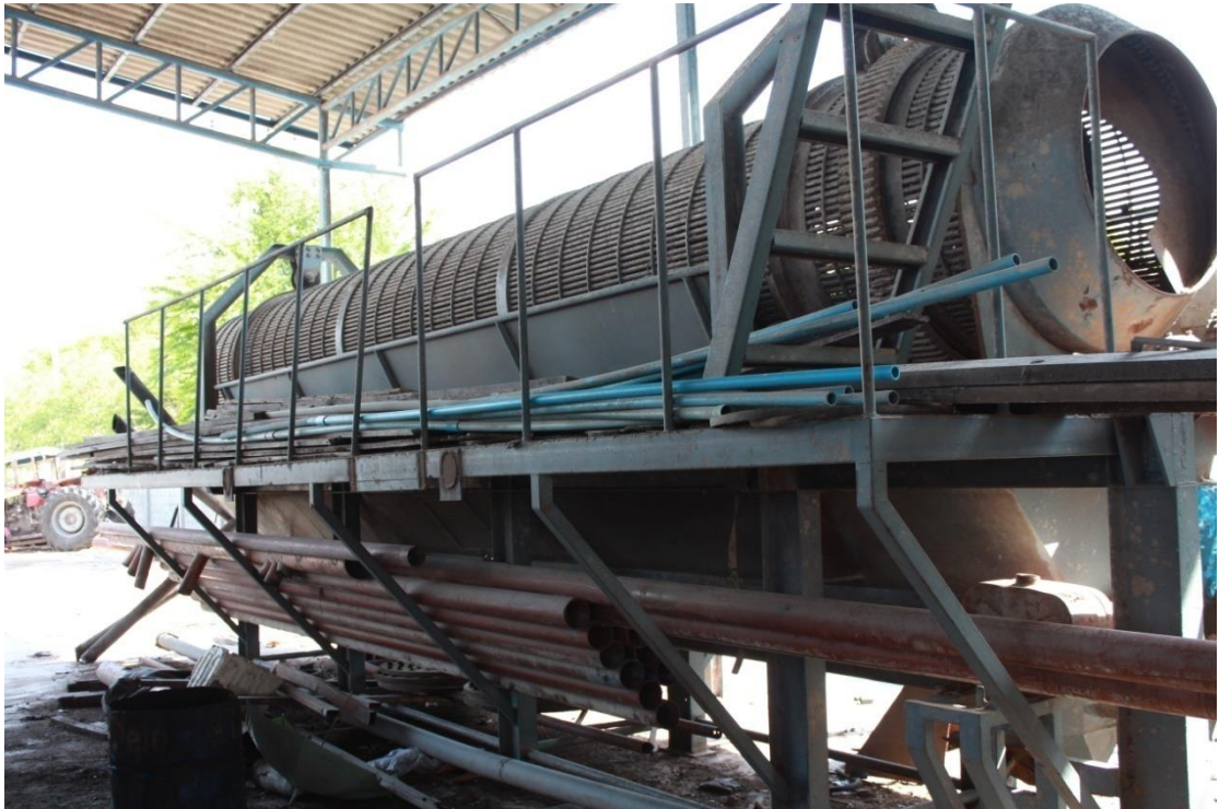
รูปที่ 8 เครื่องทำความสะอาดหัวมันสำปะหลังแบบถังตะแกรงหมุน แต่ปัจจุบันไม่ใช้งานแม้มีประสิทธิภาพในการทำความสะอาดสูง ประหยัดเนื้อที่ แต่มีความสามารถในการทำงานต่ำ ไม่ตอบสนองปริมาณการรับซื้อต่อวัน และการสับเป็นมันเส้น
