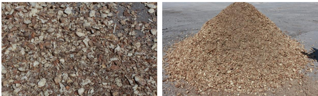
รูปที่ 1 ความไม่สม่ำเสมอของขนาด และความสะอาดของชิ้นมันเส้น
