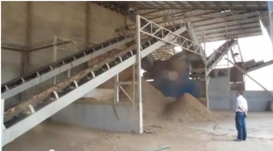
รูปที่ 6 เครื่องทำความสะอาดหัวมันสำปะหลังแบบสายพานและตะแกรงร่อน (2 ตะแกรง) เพิ่มความสามารถการทำงานโดยการเพิ่มจำนวนชุด
