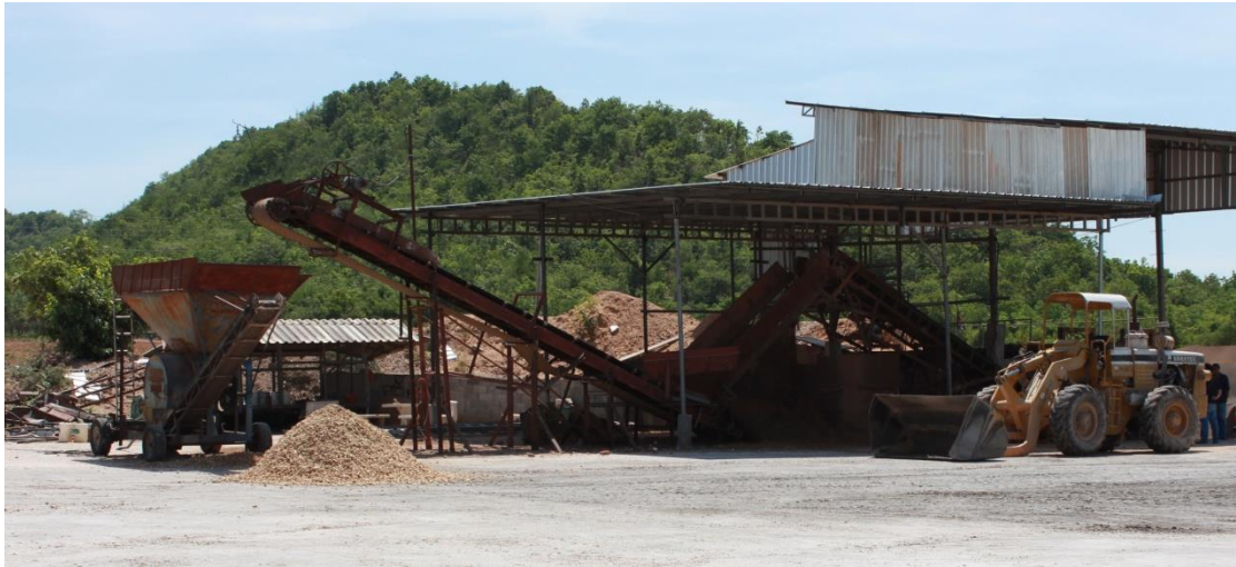
รูปที่ 5 เครื่องทำความสะอาดหัวมันสำปะหลังแบบสายพานและตะแกรงร่อน (1ตะแกรง)
