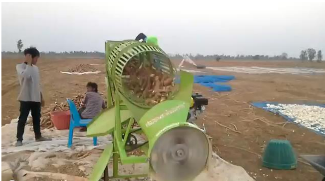
รูปที่ 4 เครื่องทำความสะอาด และสับมันสำปะหลัง
