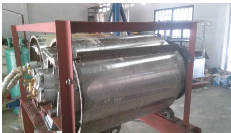
รูปที่ 7 เครื่องต้นแบบเครื่องลดความชื้นกากมันสำปะหลังแบบลูกกลิ้งคู่
