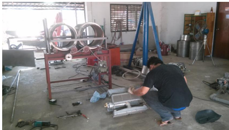
รูปที่ 9 การประกอบหัวเตาอินฟราเรดเข้าด้วยกัน
