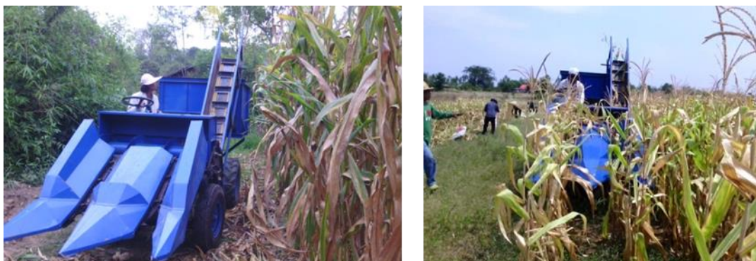
ภาพที่ 1 ลักษณะเครื่องปลิดฝักแบบสองแถวปลิด
