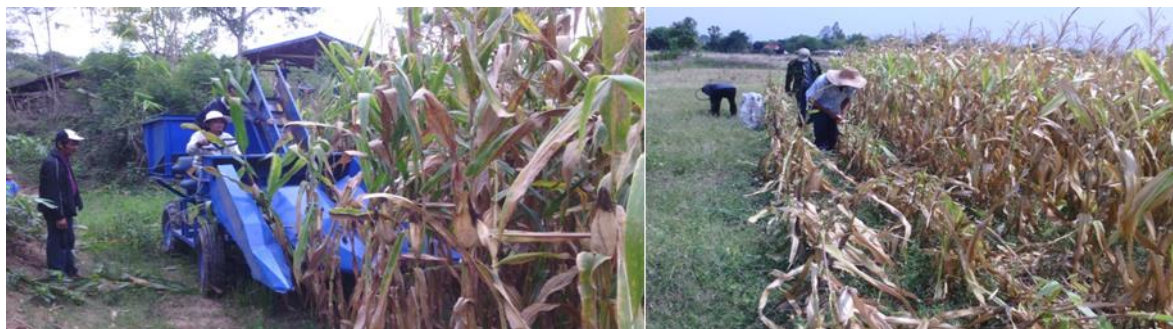
ภาพที่ 2 การทดสอบการทำงานของเครื่องปลิดฝักข้าวโพด
