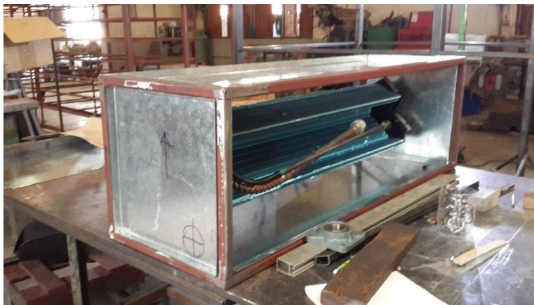
รูปที่ 9 ติดตั้งคอยล์เย็นกับโครงสร้างกล่อง
