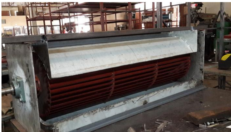
รูปที่ 10 ติดตั้งพัดลมไหลข้ามแกนกับโครงสร้างกล่อง
