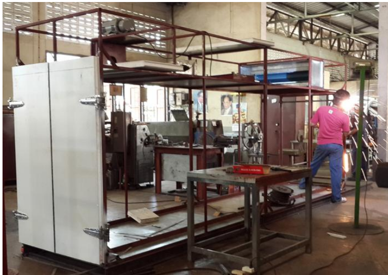
รูปที่ 6 แบบต้นแบบเครื่องผลิตลมเย็น (ขวา) แบบรถเข็น (ซ้าย); A= พัดลมแบบไหลตามแกน, B= คอยล์เย็น
