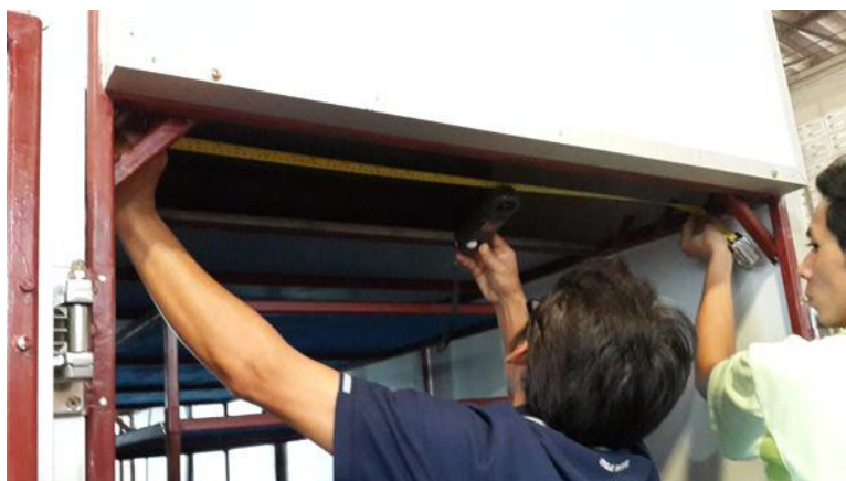
รูปที่ 17 วัดความเร็วลมที่ช่องลมด้านหน้าของต้นแบบเครื่องผลิตมเย็น
