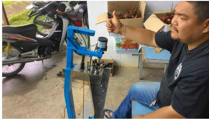
ภาพที่ 7 การทดสอบเครื่องคว้านเมล็ดลิ้นจี่แบบใช้มอเตอร์ไฟฟ้าเป็นต้นกำลัง
