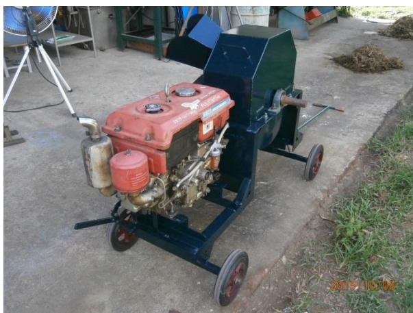
ภาพที่ 13 ต้นแบบเครื่องหั่นย่อยเปลือกฝักข้าวโพดเลี้ยงสัตว์
