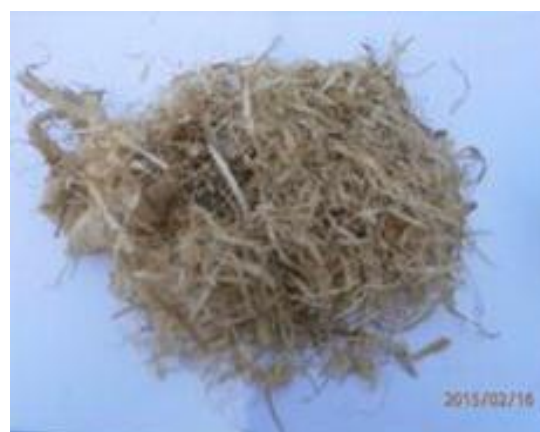
ภาพที่ 6 ทดสอบเบื้องต้นโดยใช้เครื่องหั่นย่อยกิ่งผลไม้
