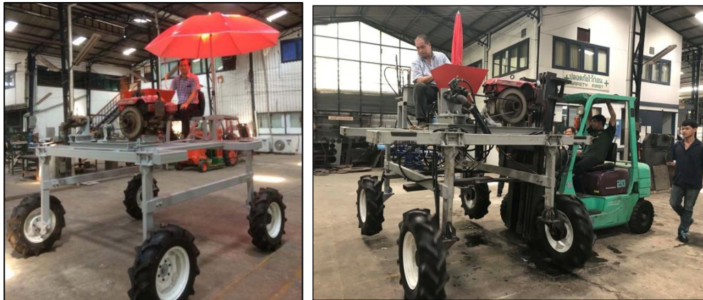
ภาพที่ 19 การทดสอบมุมเอียงที่ปลอดภัย ด้านซ้าย และด้านขวา
