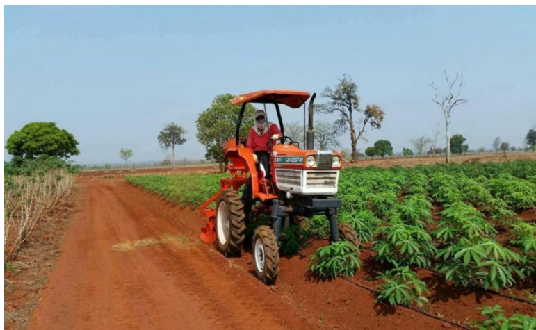
ภาพที่ 9 รถแทรกเตอร์ ขนาดเล็ก 22 แรงม้า ดัดแปลงเป็นแบบยกสูง
