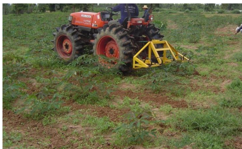
ภาพที่ 8 การทดสอบคราดสปริงติดพ่วงท้ายรถแทรกเตอร์ขนาด 34 แรงม้า
