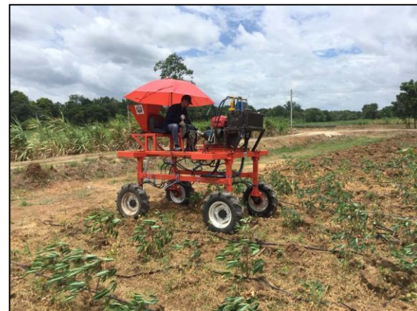
ภาพที่ 23 ทดสอบเคลื่อนที่บนพื้นผิวดินลูกรัง และในไร่มันสำปะหลัง
