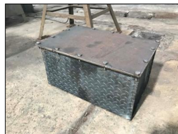
ถังเก็บน้ำมันไฮดรอลิก
