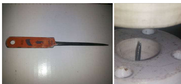
รูปที่ 8 ลักษณะของใบมีดคว้านที่สร้างขึ้น(ซ้าย)และการติดตั้ง
