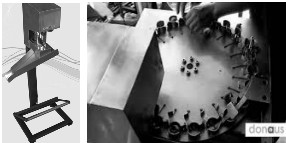
รูปที่ 4 เครื่องคว้านเมล็ดลำไยโดยบริษัทเอกชน
