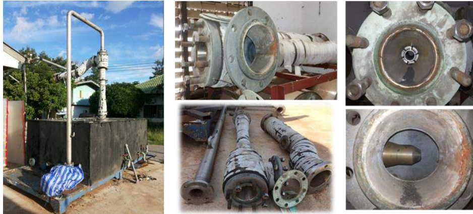
ภาพที่ 4.8 นำปั๊มลดแรงดันแบบ water jet มาศึกษาวิเคราะห์เพื่อเป็นแนวทางในการสร้าง
