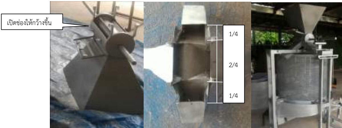
ภาพที่ 2.41 ช่องปล่อยและช่องป้อนพริกแบบสี่ช่องป้อนที่แก้ไขเพิ่มเติม
