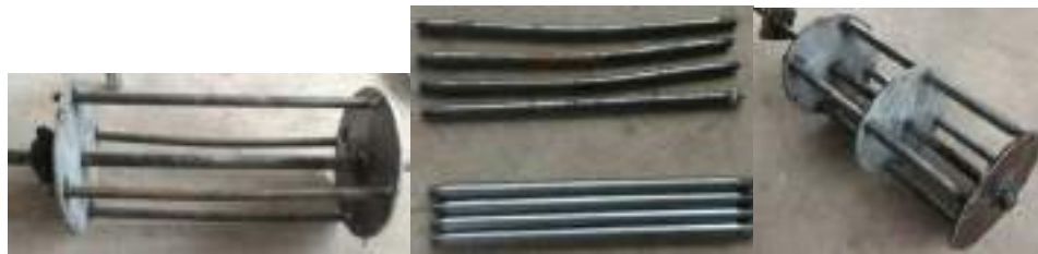
ภาพที่ 2.49 ก) การโค้งตัวของเพลลาตีแยกเมล็ด ข) เพลลาเดิมและเพลลาใหม่ ค) การประกอบเพลลาใหม่และเหล็กหน้าแปลนยึดเพิ่มเพื่อความแข็งแรง
