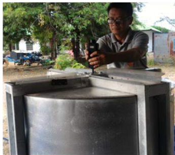
ภาพที่ 2.24 ใช้อุปกรณ์วัดความเร็วรอบเพลลา
