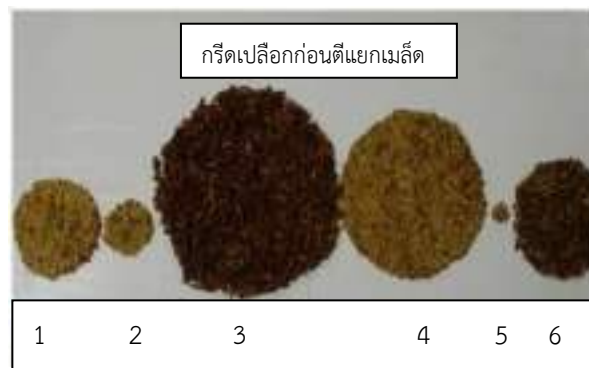
ภาพที่ 2.33 ผลการแยกเมล็ดออกจากเปลือกของพริกซูเปอร์ฮอต ที่ความเร็ว 32.2 เมตรต่อวินาที
