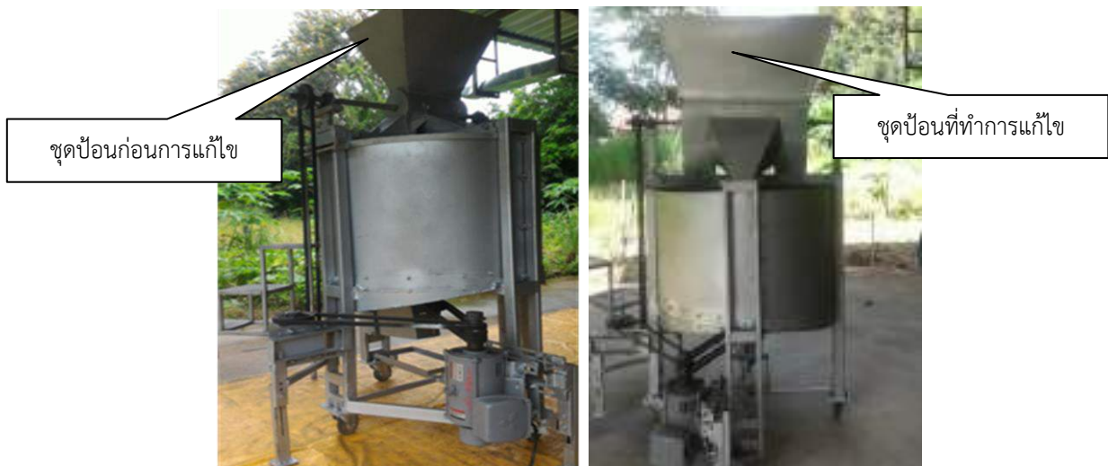
ภาพที่ 2.56 ชุดป้อนพริกเข้าเครื่องตีแยกเมล็ดพริกออกจากเปลือกที่ทำการแก้ไขให้ใหญ่ขึ้น
