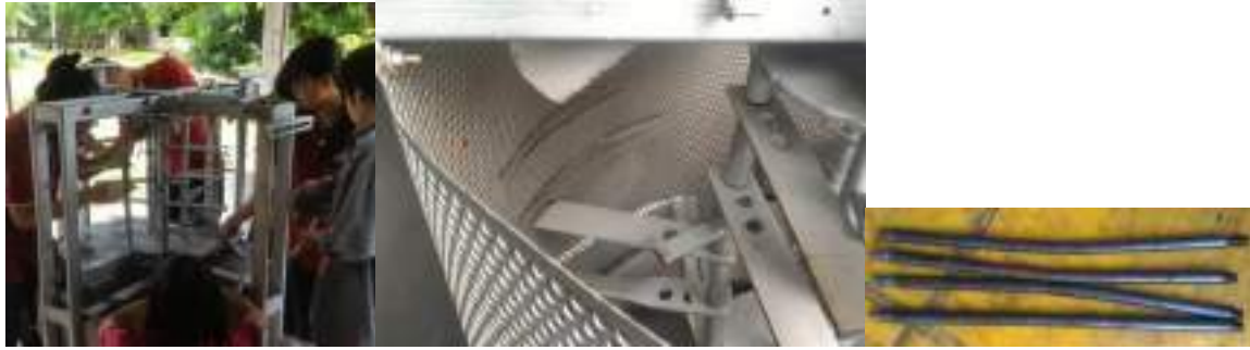
ภาพที่ 2.48 การโค้งตัวของเพลลา และการฉีดขาดของตะแกรง
