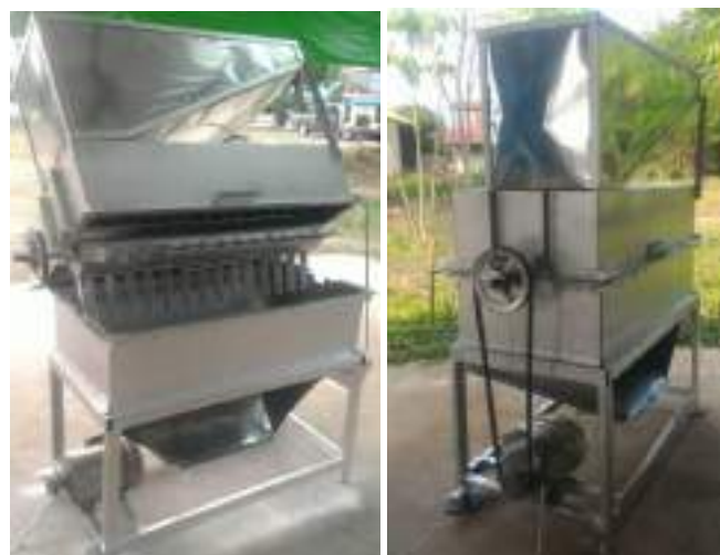
ภาพที่ 2.68 เครื่องต้นแบบ เครื่องตีแยกเมล็ดมะเขือเทศออกจากเปลือก ผลการทดสอบการทำงานของเครื่องต้นแบบ
