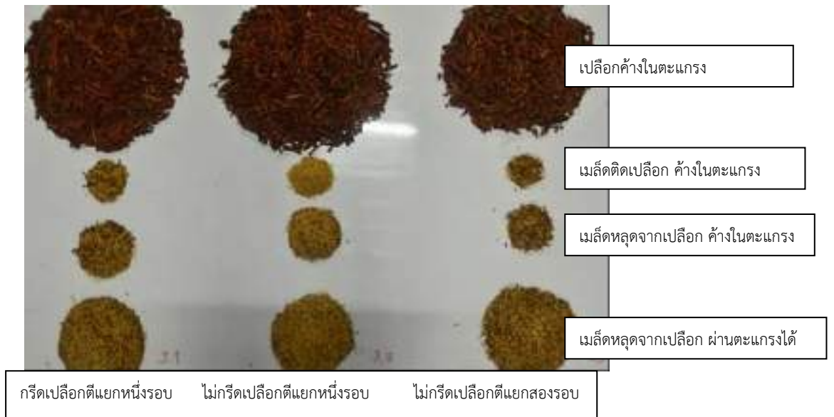
ภาพที่ 2.43 ผลการตีแยกเมล็ดออกจากเปลือกของพริกแห้งจินดาแดงแบบกริตเปลือกและไม่กริตเปลือก
