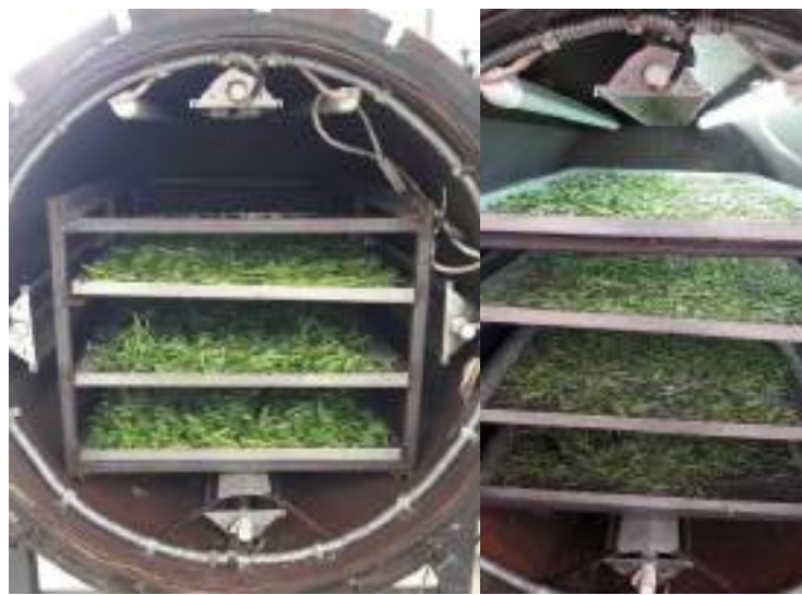
ภาพที่ 4.16 ทดสอบอบแห้งผักบุงเพื่อหาความสัมพันธ์ของความชื้นในห้องอบแห้งกับความชื้นในผลิตภัณฑ์
