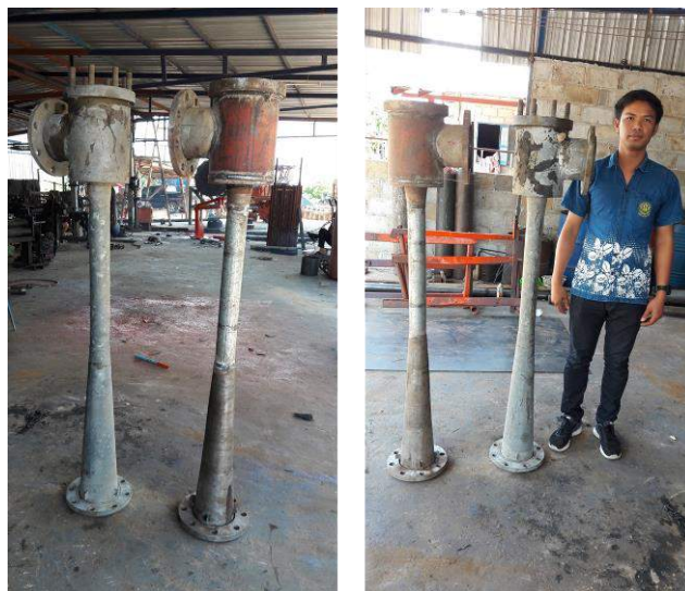
ภาพที่ 4.11 ประกอบเป็นชุดหัวพ่นน้ำแรงดันสูง และมีขนาดเท่ากับของต่างประเทศ
