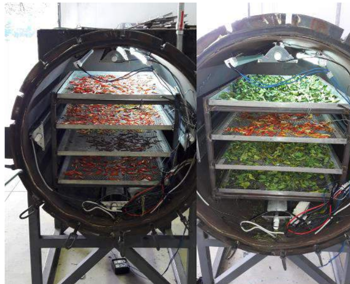
ภาพที่ 4.20 การทดสอบอบแห้งพืชผักและสมุนไพรบางชนิด
