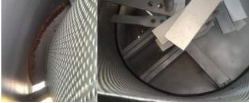
ภาพที่ 2.44 ผลการตกค้างของเมล็ดที่ผ่านตะแกรงออกมาและเปลือกพริกแห้งจินดาแดงในตะแกรง
