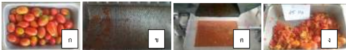
ภาพที่ 2.70 ก) มะเขือเทศที่ใช้ทดสอบ ข) เมล็ดมะเขือเทศค้ำในตะแกรง ค) เมล็ดมะเขือเทศผ่านตะแกรงลงสู่ช่องรับเมล็ด ง) เปลือกมะเขือเทศที่ถูกแยกออกสู่ช่องรับเปลือก
