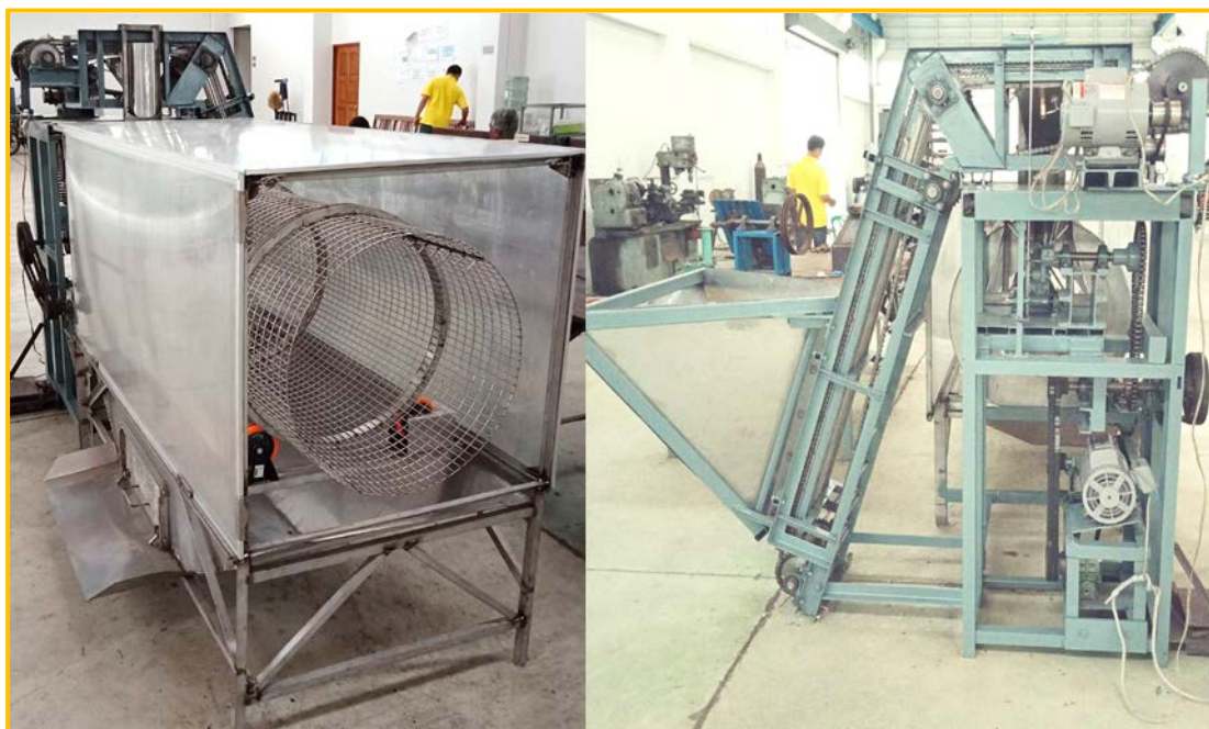
รูปที่ 23 เครื่องต้นแบบแยกเมล็ดโกโก้ออกจากผลพร้อมทดสอบครั้งที่ 2
