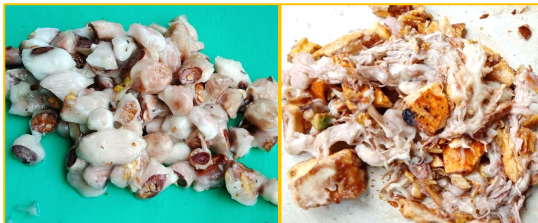
รูปที่ 26 เมล็ดโกโก้ที่เสียหายหลังผ่านเครื่อง รูปที่ 27 สิ่งเจือปนหลังผ่านเครื่อง(เศษเปลือก, พวงเมล็ด)
