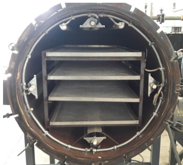
ภาพที่ 13 การปรับปรุงระบบสายไฟฟ้าและเซนเซอร์ของห้องอบแบบชั้นวางให้เรียบร้อย
