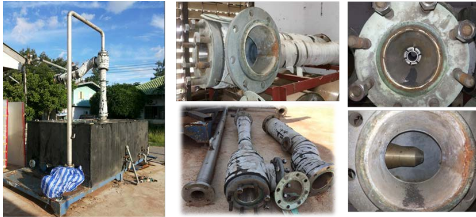
ภาพที่ 8 นำปั๊มลดแรงดันแบบ water jet มาศึกษาวิเคราะห์เพื่อเป็นแนวทางในการสร้าง
