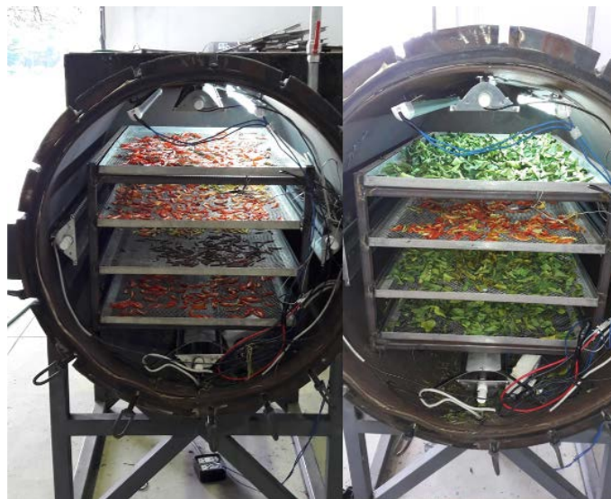
ภาพที่ 20 การทดสอบอบแห้งพืชผักและสมุนไพรบางชนิด
