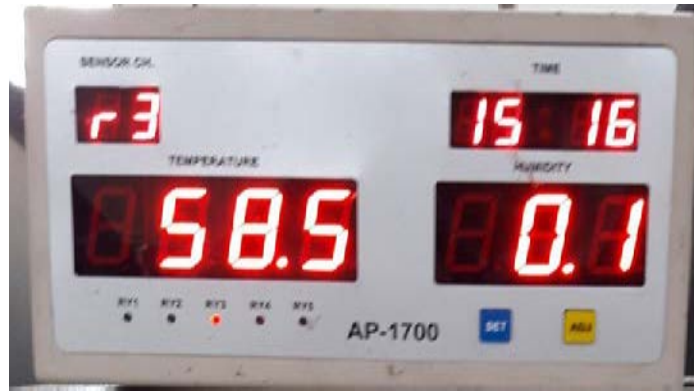
ภาพที่ 15 ความชื้นอากาศในห้องอบแห้งที่ไม่มีผลิตภัณฑ์ เข้าใกล้ศูนย์
