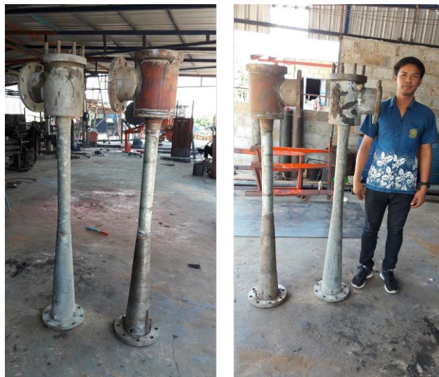
ภาพที่ 11 ประกอบเป็นชุดหัวพ่นน้ำแรงดันสูง และมีขนาดเท่ากับของต่างประเทศ
