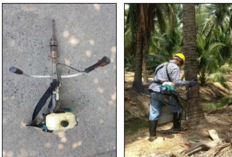
ภาพที่ 1.2 ส่วนที่ดัดแปลงจากเครื่องตัดหญ้า และวิธีการเจาะต้น
