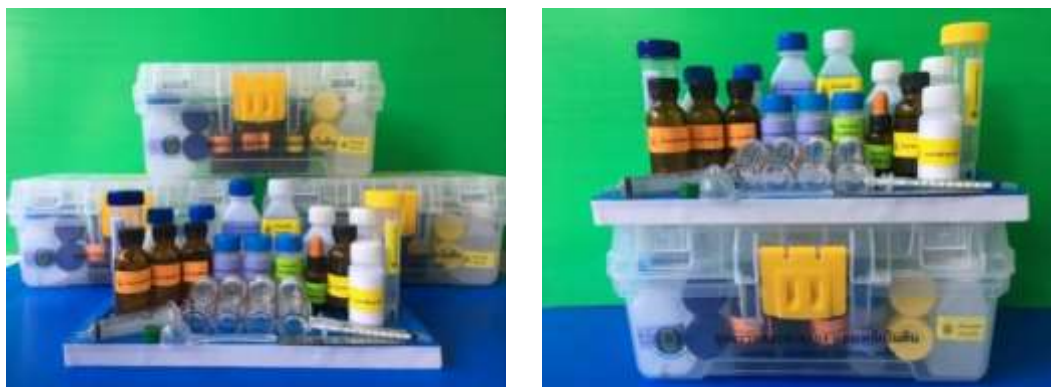
ภาพที่ 2 ชุดตรวจสอบธาตุอาหารรอง และเหล็กที่เป็นประโยชน์ในดิน
