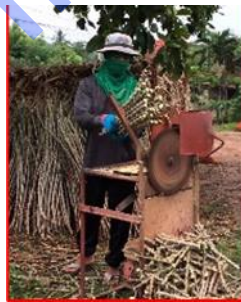
ภาพที่ 4 การตัดท่อนพันธุ์โดยใช้แรงงานคน และเครื่องตัดท่อนพันธุ์ที่พัฒนาขึ้นเองในแต่ละพื้นที่
