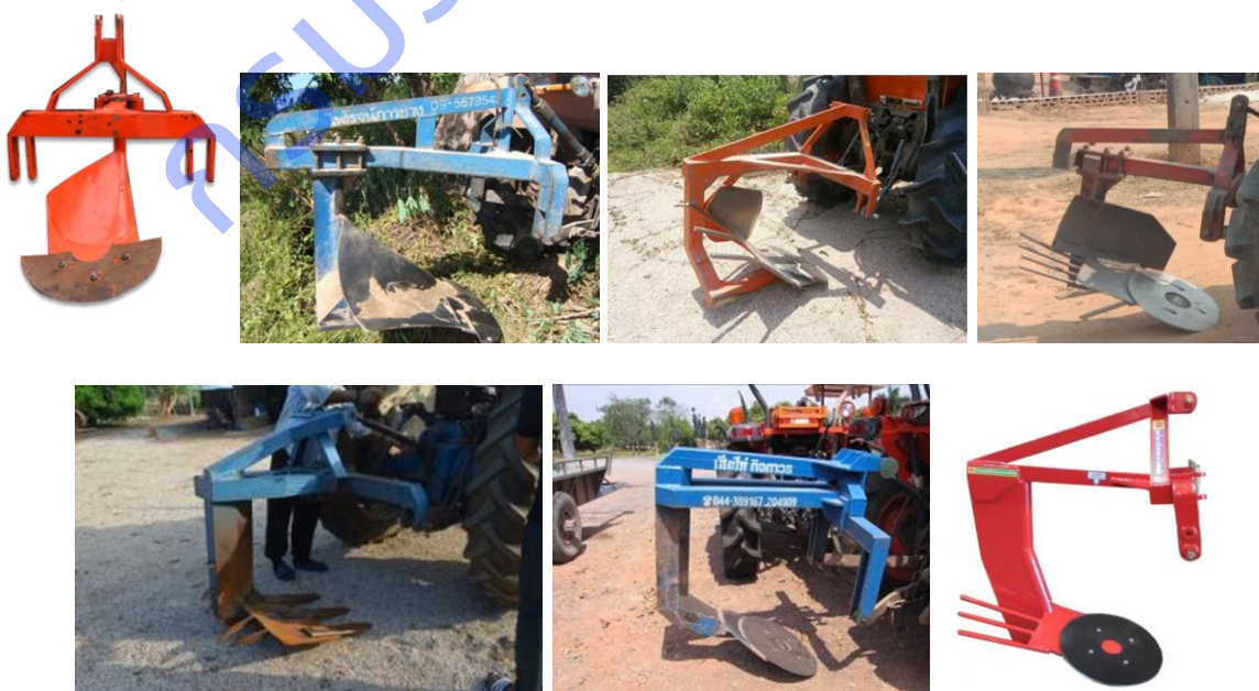
ภาพที่ 12 ส่วนหนึ่งของผานขุดมันสำปะหลังในแต่ละภูมิภาคที่เกษตรกรใช้งานซึ่งมีหลากหลายรูปแบบมาก
