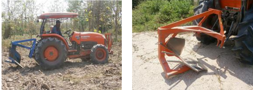
ภาพที่ 17 ผาลชุดมันสำปะหลังต้นแบบงานวิจัย (ก) และผาลชุดมันสำปะหลังของเกษตรกร (ข)
