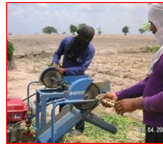
ภาพที่ 4 การตัดท่อนพันธุ์โดยใช้แรงงานคน และเครื่องตัดท่อนพันธุ์ที่พัฒนาขึ้นเองในแต่ละพื้นที่
