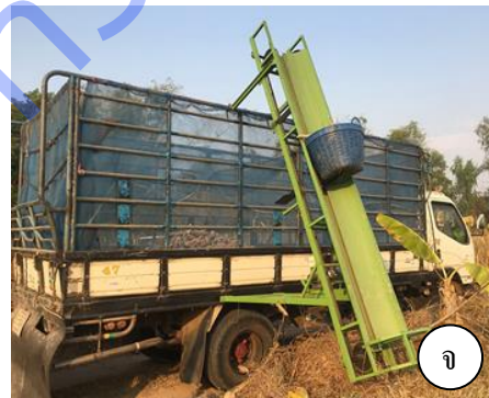
ภาพที่ 1 เครื่องต้นแบบงานวิจัยที่เลือกมาดำเนินการ ได้แก่ เครื่องตัดท่อนพันธุ์มันสำปะหลัง (ก) เครื่องกำจัดวัชพืชและใส่ปุ๋ยแบบต่อพ่วงกับรถไถเดินตาม (ข) เครื่องขุดมันสำปะหลังแบบไถหัวหมู (ค) เครื่องเก็บเกี่ยวมันสำปะหลังแบบกึ่งอัตโนมัติ (ง) และเครื่องลำเลียงหัวมันสำปะหลังขึ้นรถบรรทุก (จ)
