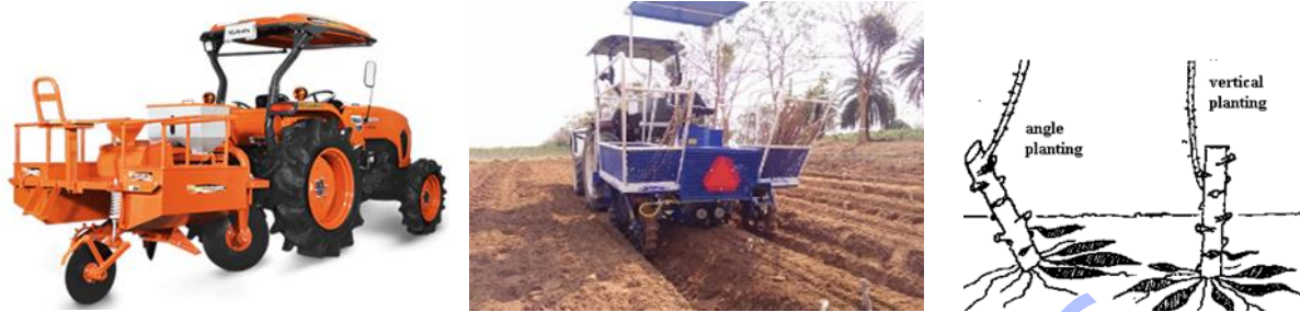
ภาพที่ 6 เครื่องปลูกมันสำปะหลังแบบปักท่อนพันธุ์ในแนวตั้ง
