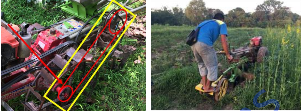
ภาพที่ 13 ปัญหาการติดตั้งถังปุ๋ย และการปรับปรุงแก้ไขเครื่องต้นแบบเพื่อเพิ่มประสิทธิภาพด้วยการเพิ่มอุปกรณ์เพื่อลดความเหนื่อยล้าจากการเดิน
