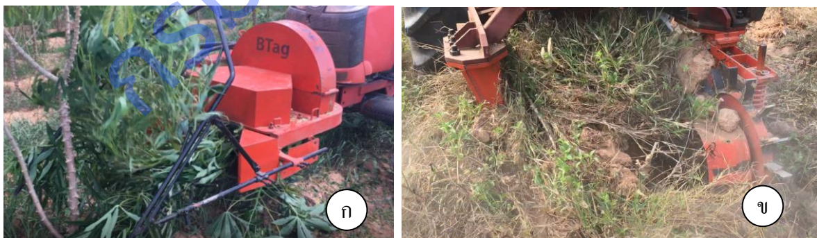
ภาพที่ 18 เครื่องตัดและสับย่อยต้นมันสำปะหลังที่มีปัญหาการอุดต้น และส่วนของการชุดที่มีปัญหาการสะสมของเศษวัชพืช กิ่ง และต้น ซึ่งมีแนวทางแก้ไขได้แล้ว (ข)
